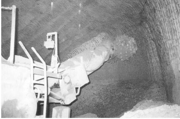
Figure 4-5 :Haveuse en action [BRÄNDLI ET AL., 1990].
