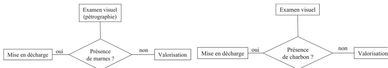
**Figure 7-10 : Méthodologie de sélection, Mt. Terri et Vue-des Alpes** - **Figure 7-11 : Méthodologie de sélection, galeries CFF Vernayaz**
