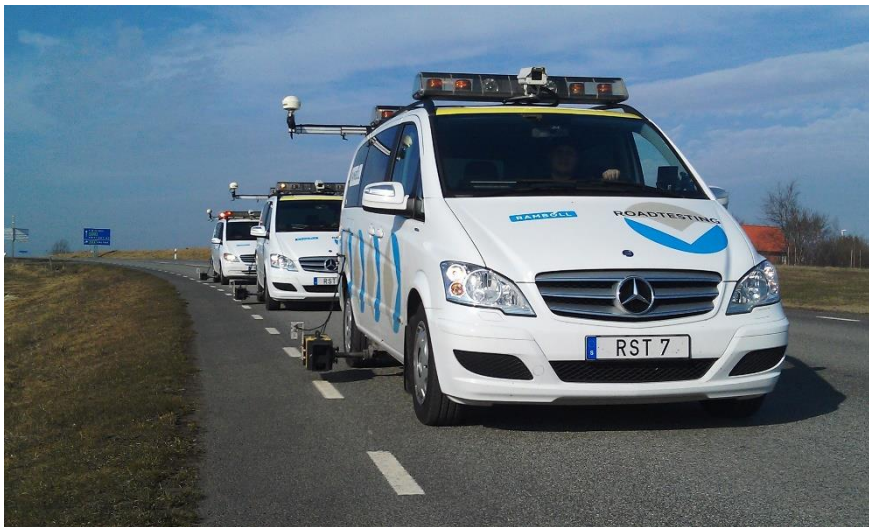
Figur 5. Det mobila mätsystemet Road Marking Tester (RMT). Instrumentet som mäter retroreflexion och MPD är monterat på sidan av fordonet. Foto: Berne Nielsen, Ramböll.
