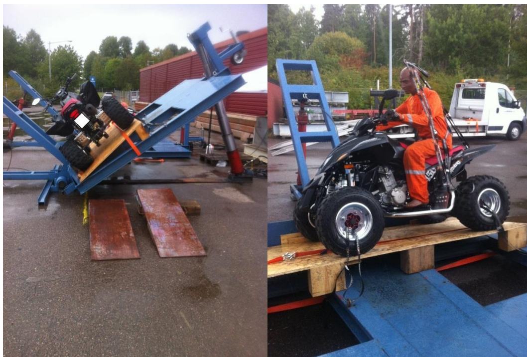
Figur 1. Test med tiltbord med och utan krocktestdocka.
