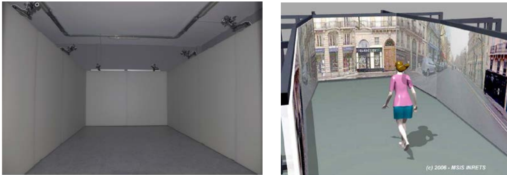
Figure 19. Simulateur immersif et interactif de traversée de rue de l’Ifsttar, à Versailles-Satory.
