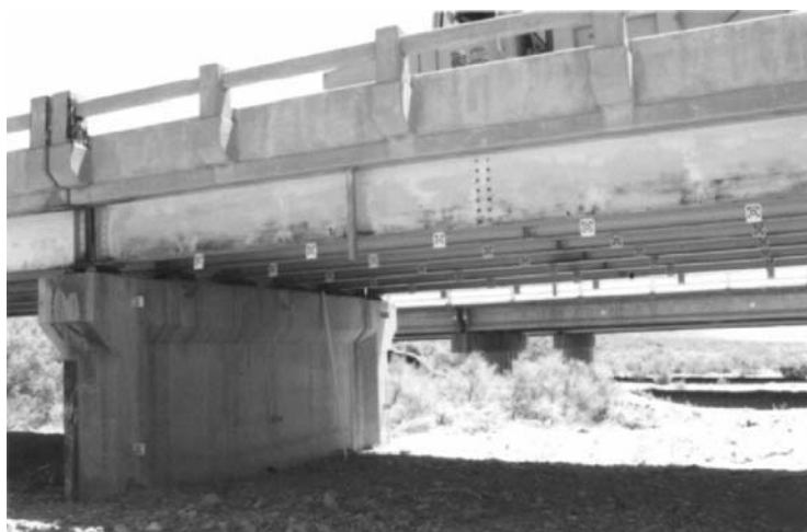
Figure 23: Cibles pour mesures photogrammétriques sur le Pont d'Alamosa Canyon, Nouveau Mexique [21]
