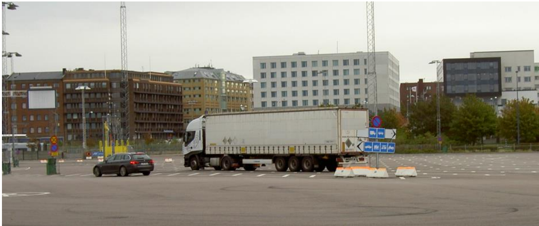
Figur 3. Majoriteten av de utländska lastbils ekipagen utgjordes av dragbilar med påhängsvagn och bland dem dominerade en axelkonfiguration enligt bilden: två axlar på dragbilen och tre axlar på påhängsvagnen. Totalvikten uppskattas till 40 ton. Från Helsingborgs hamnområde. Foto: Mohammad-Reza Yahya, 2015.
