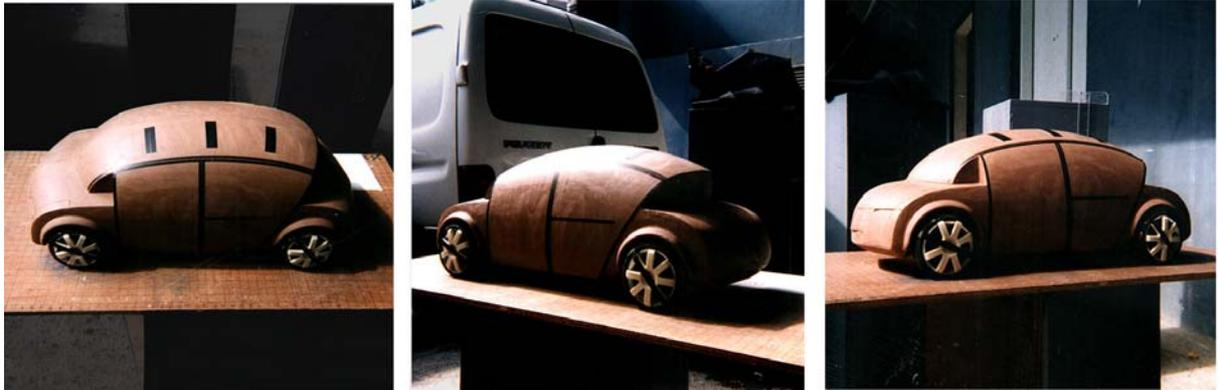
*Figure III. 19 : maquettes Clay*
