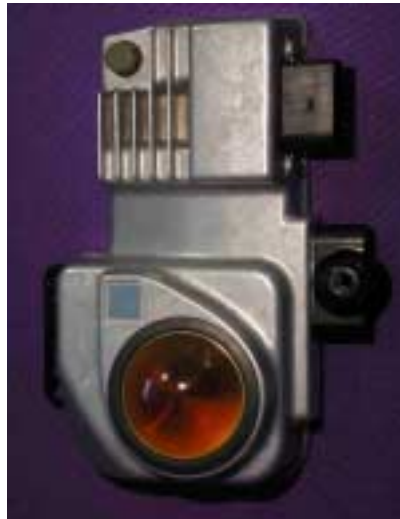
Fig. 3: Thales Long Range Radar
