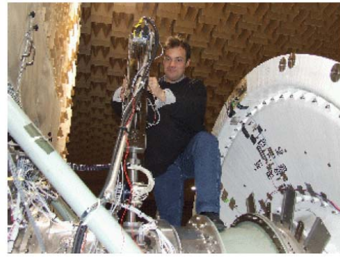
(b) Fan-OGV gap hot wire probe
