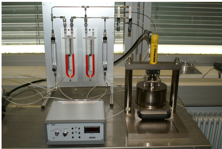
Abbildung 4.3: Versuchsanordnung für die Sauerstoffdiffusions-Prüfung.
