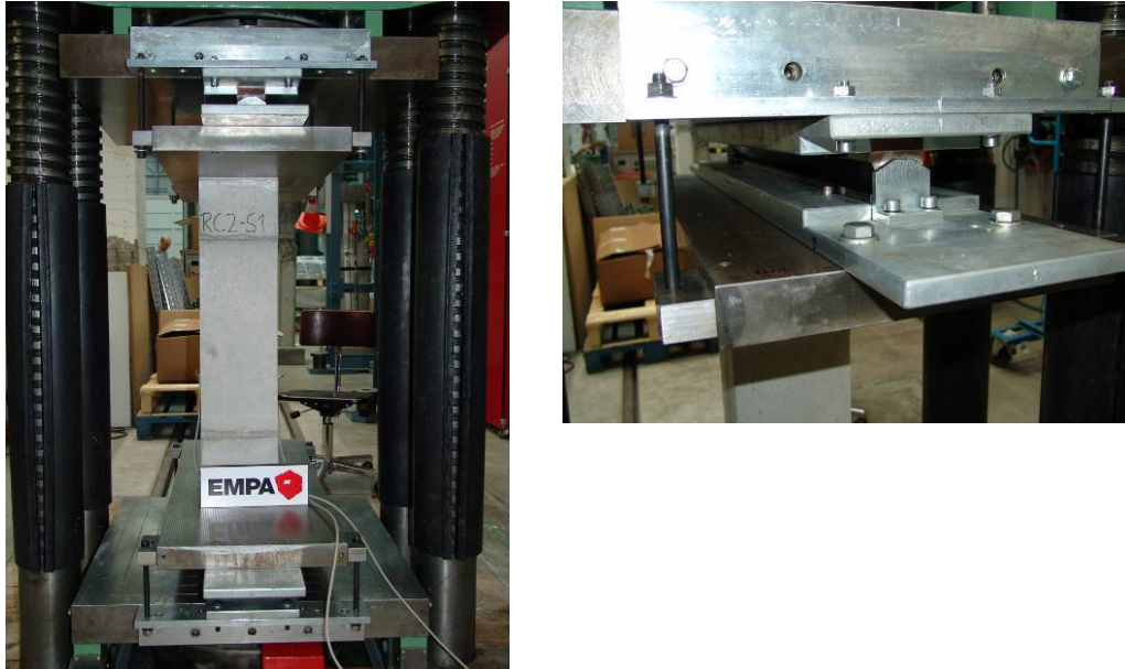
Abbildung 3.9: Prüfkörper zwischen zwei Linienkipplagern (links), Linienkipplager (rechts)
