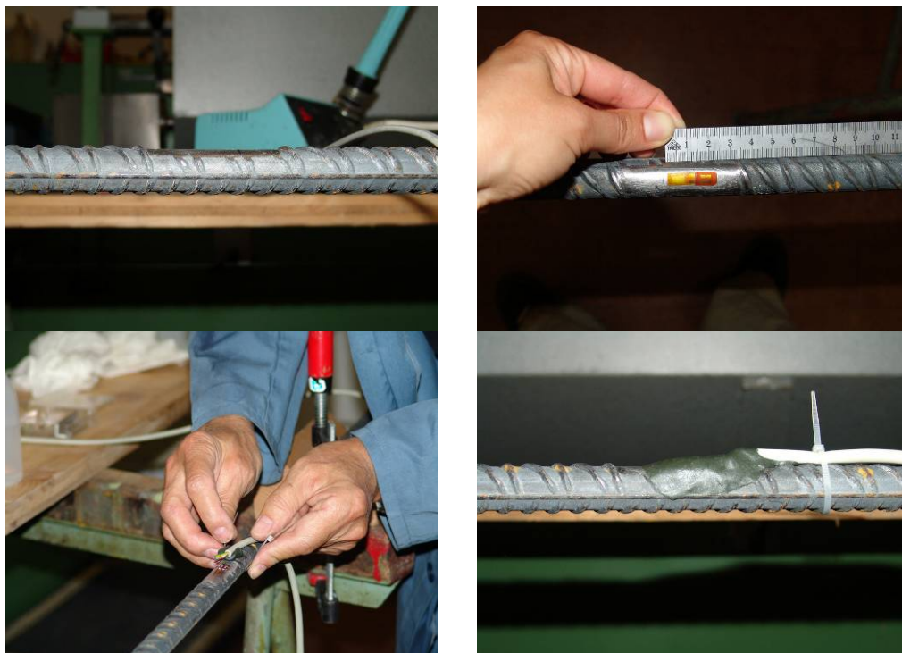
Abbildung 5.7: Aufkleben der Dehnmessstreifen auf den Bewehrungsstahl: 1. oben links: Abschleifen der Rippen, 2. oben rechts: Aufkleben des DMS, 3. unten links: Anlöten des Kabels, 4. unten rechts: Abdichten der Messstelle.
