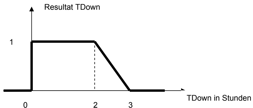
Abb. 1-15 Resultatwert von TDown des Moduls Temperaturnulldurchgang
