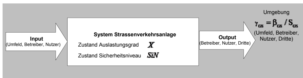
Abb. 2.7 Funktionales Systemkonzept der Strassenverkehrsanlage an Autobahnen
