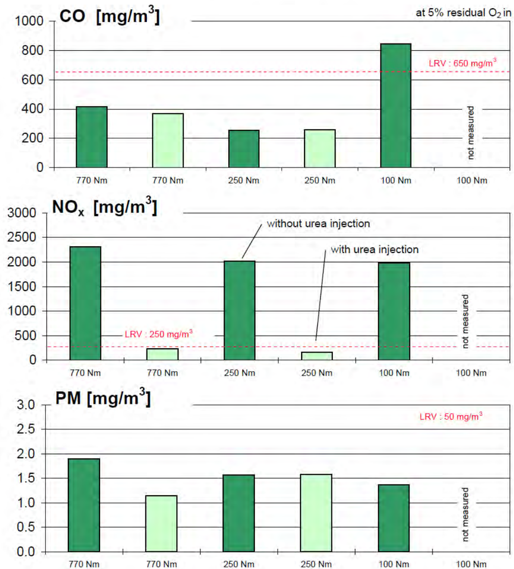
Abbildung 108: Emissionen bei unterschiedlichen Betriebspunkten - mit und ohne Harnstoff-Dosierung.
