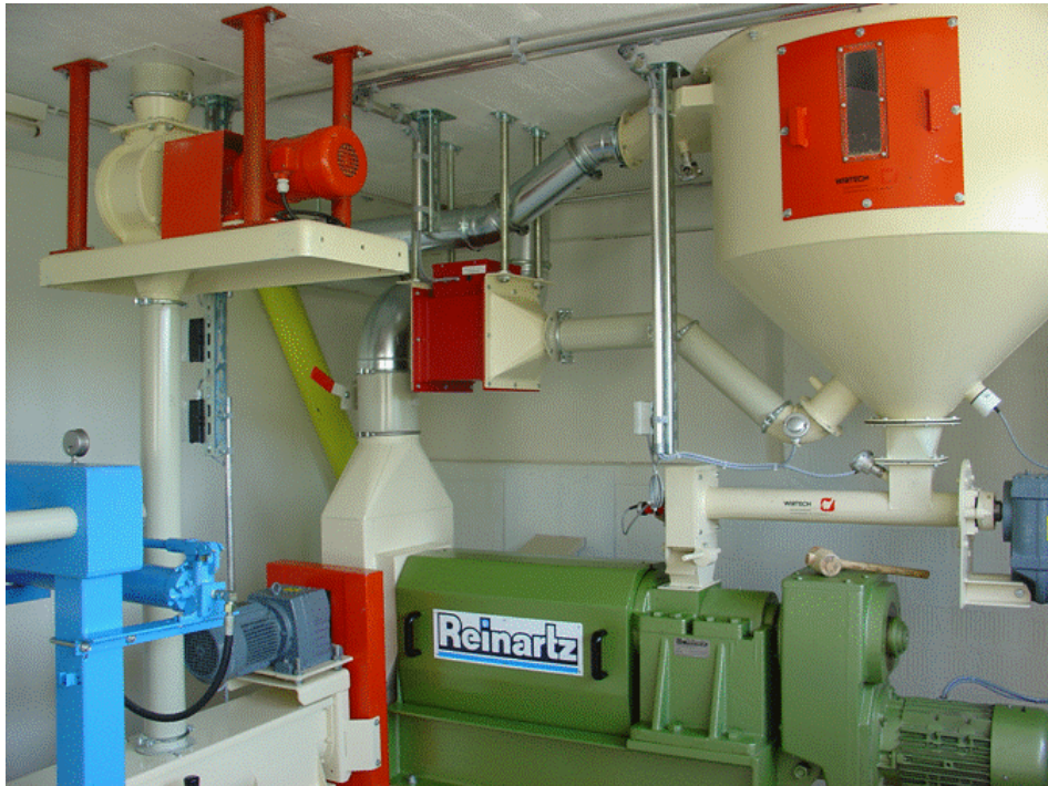
Abbildung 8: Die Presse (unten), mit beheizbarem Speisedepot und Dosierschnecke (oben und rechts).
