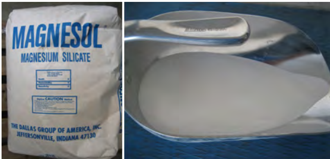
Abbildung 27: Das Adsorbtiionsmittel Magnesol in der Verpackung (20 kg Sack, links) und auf einer Schöpfkelle (rechts).
