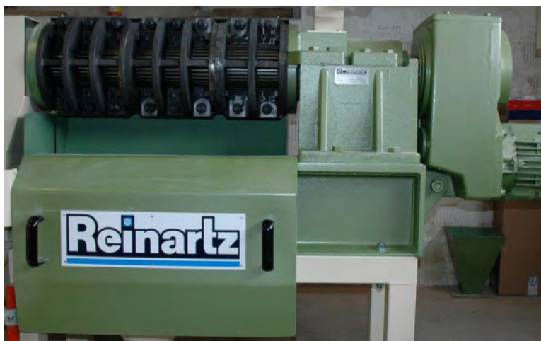
Abbildung 11: Die Seiherschneckenpresse Reinartz AP 10/06.
