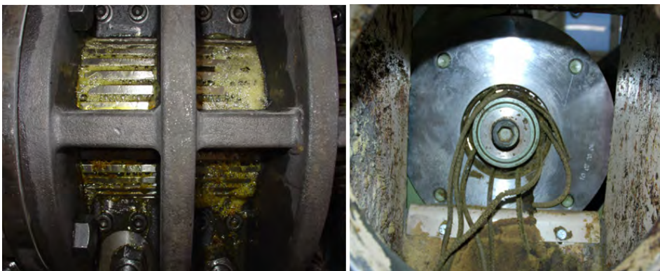
Abbildung 13: Links eine Nahaufnahme eines Seihersegmentes mit laufender Öldrainage, rechts der Presskopf mit den heraustretenden Presskuchensträngen.
