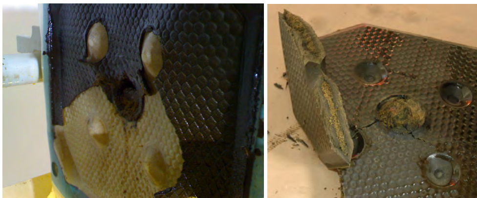
Abbildung 25: Filterkuchen in der Kammerfilterpresse ohne (links) und mit Filterhilfsmittel (rechts). Ohne Filterhilfsmittel baute sich kein kompakter Kuchen auf.
