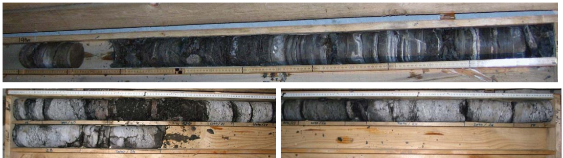
Abb. 4.6 Ausgelegte Kernstrecken (oben TM 935 Tiefe 9.00 m – 10.40 m, unten TM 2040 Tiefe: 8.00 m – 10.54 m) zwecks geologisch-petrographischer Aufnahme
