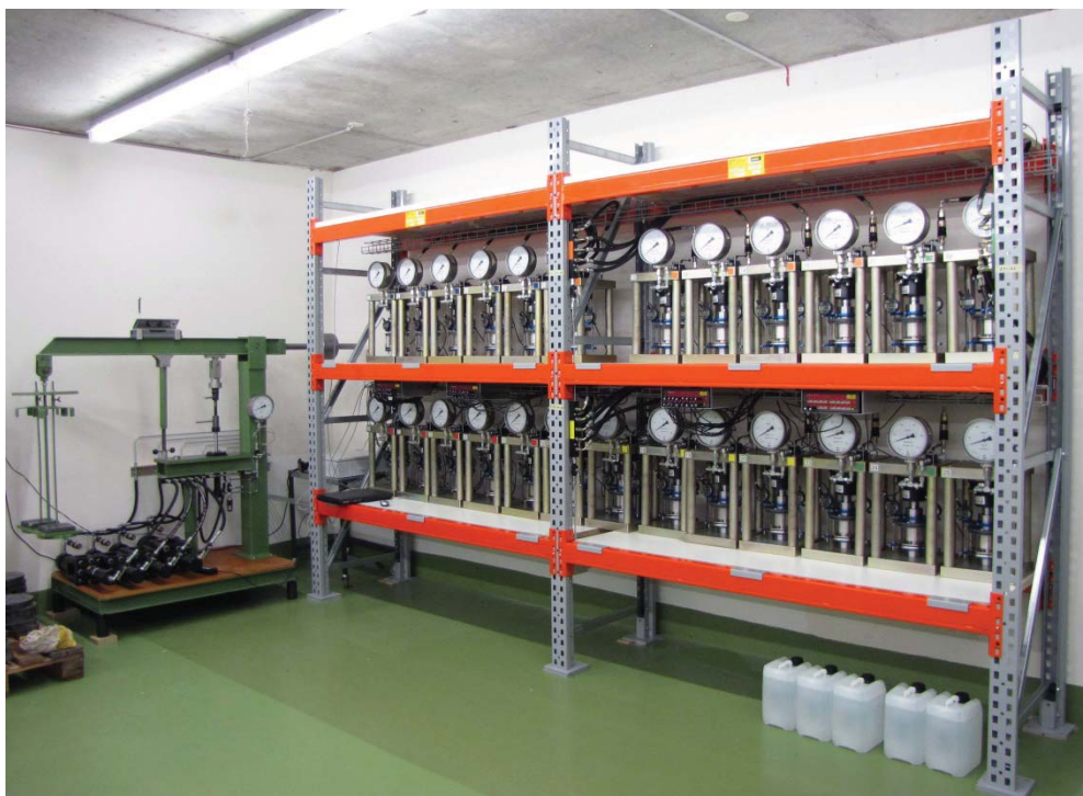
Abb. 6.25 Prüfanlage im Klimaraum: Druckerzeuger und Druckübersetzer (rechts) und Prüfraum (links)
