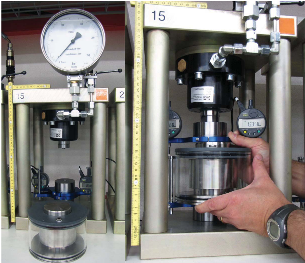
Abb. 6.24 Wassertopf vor (links) und während des Einbaus in dem Prüfraum (rechts)
