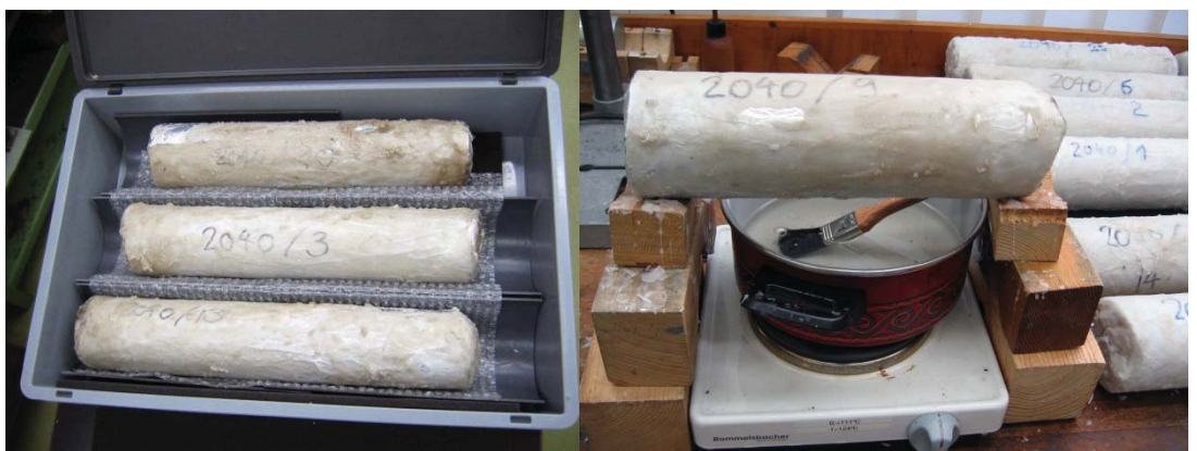
Abb. 4.7 Schutz der Bohrkern (links transportfertig, rechts Vervollständigung des Paraffinüberzugs)
