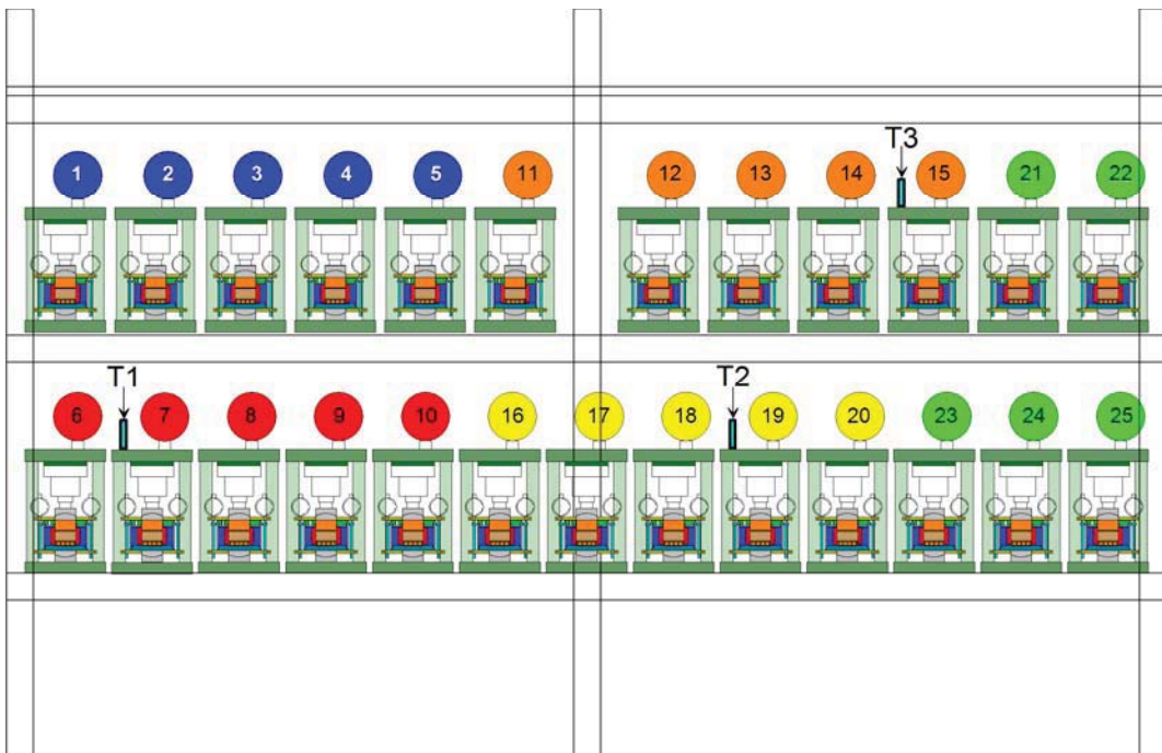
Abb. 6.22 Lage der Temperatursensoren T1 bis T3 und Verteilung der Prüfrahmen auf dem Schwerlastenregal
