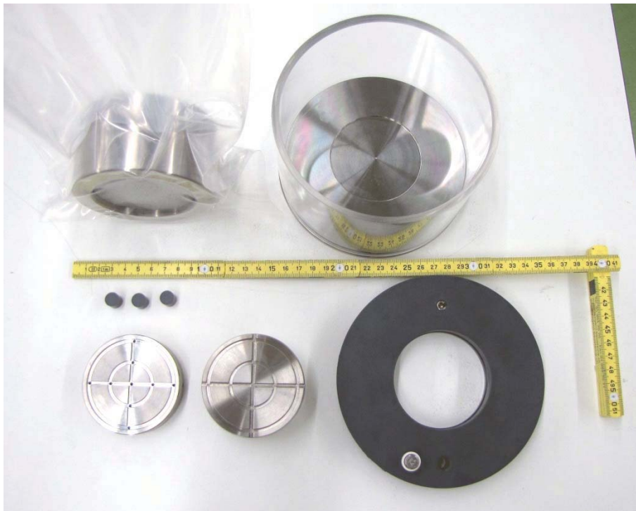
Abb. 6.23 Prüfkörpereinbau: Prüfkörper samt Filterplatten im Ödometerring vor dem Einbau (links oben), Wassertopf (rechts oben), Kopfplatten und Topfdeckel (unten)
