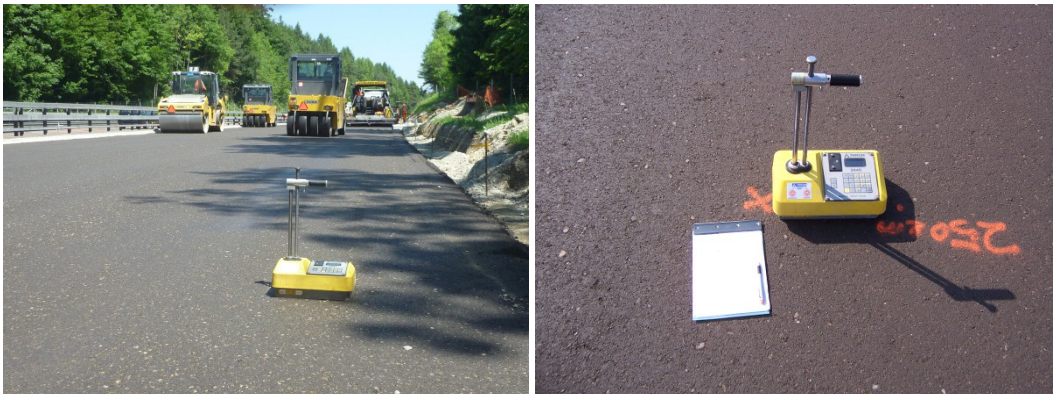
Abbildung 42: Messung mit der Isotopsonde.
