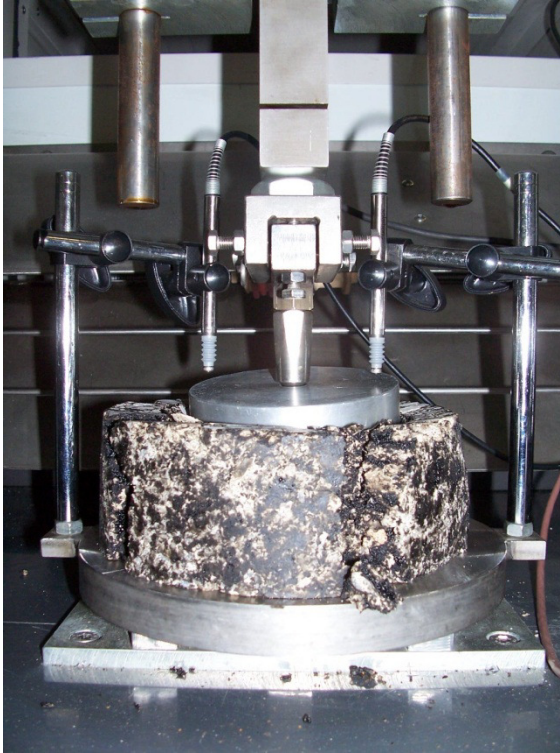
Abbildung 37: Kollaps eines Gyratorprüfkörpers, KMF.
