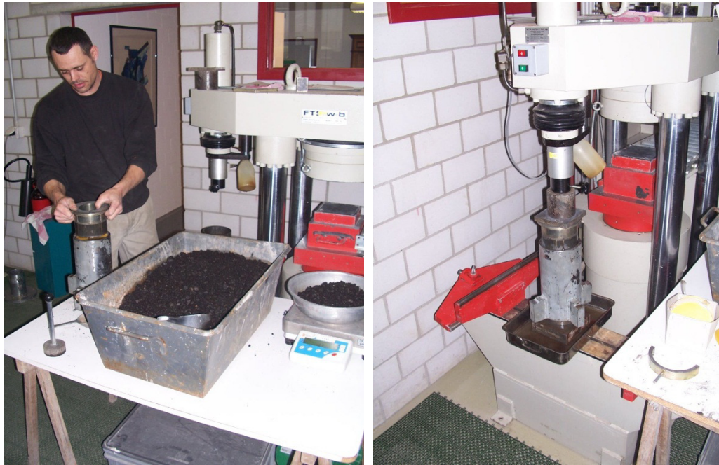
Abbildung 8: Duriez-Verdichtung im Labor.
