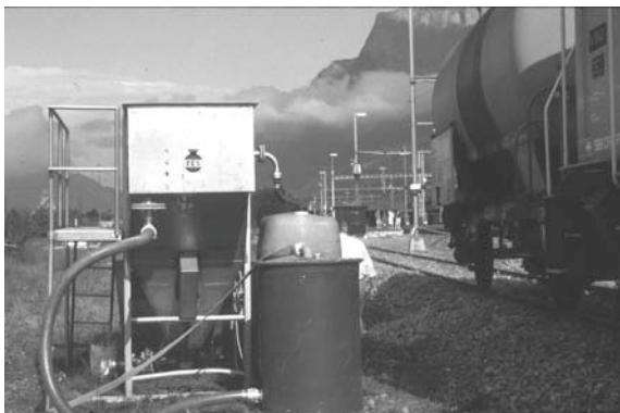
Bild A3.7: Abscheider und Zisternenwagen für Abwasser
