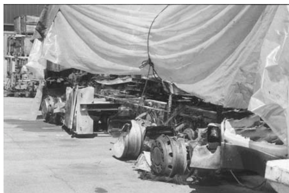
Bild A7.6: Ausgebranntes Tankfahrzeug
