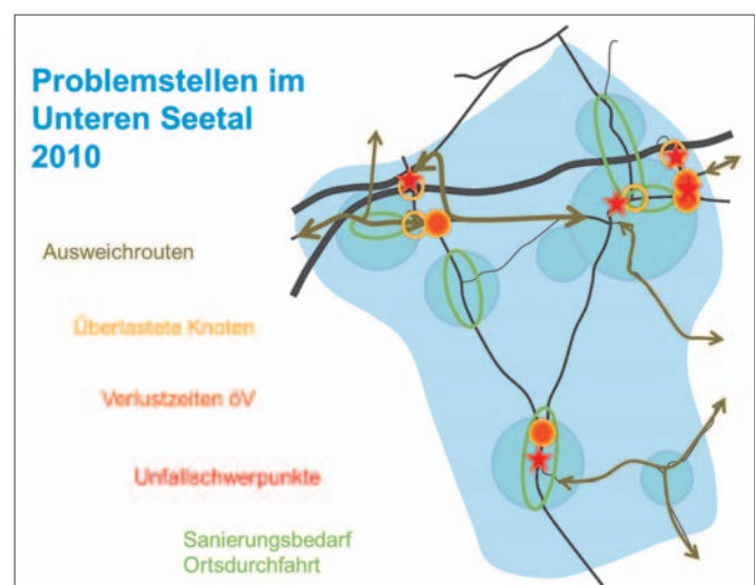
3 | Problemstellen 2010 Unteres Seetal. 3 | Endroits problématiques 2010 du Seetal inférieur.
