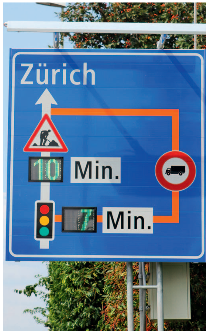
10 | Schweizweit bisher einmalig: Das Wechselsignal mit Minutenanzeige für die beiden Routen durch und um die Baustelle.
