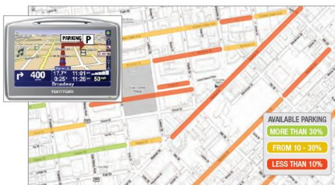
Abb. 3.22 Parking Management „Streetline“, Parkleitung via Mobiltelefon (Quelle: www.streetlinenetworks.com )
