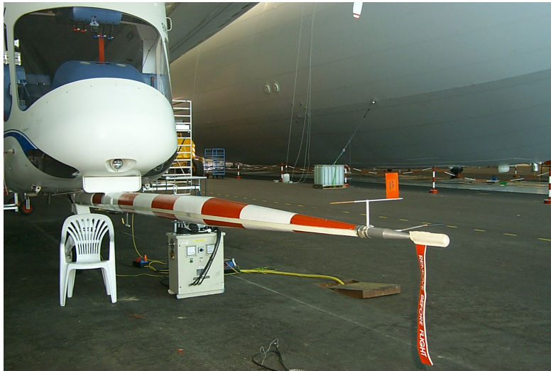
Bild 85 Noseboom mit alpha-beta-Fahnen und Prandl-Rohr
