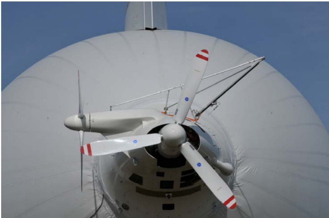
Bild 86 Aufbau der NERSOP-Meßanlage am Heck des Luftschiffes
