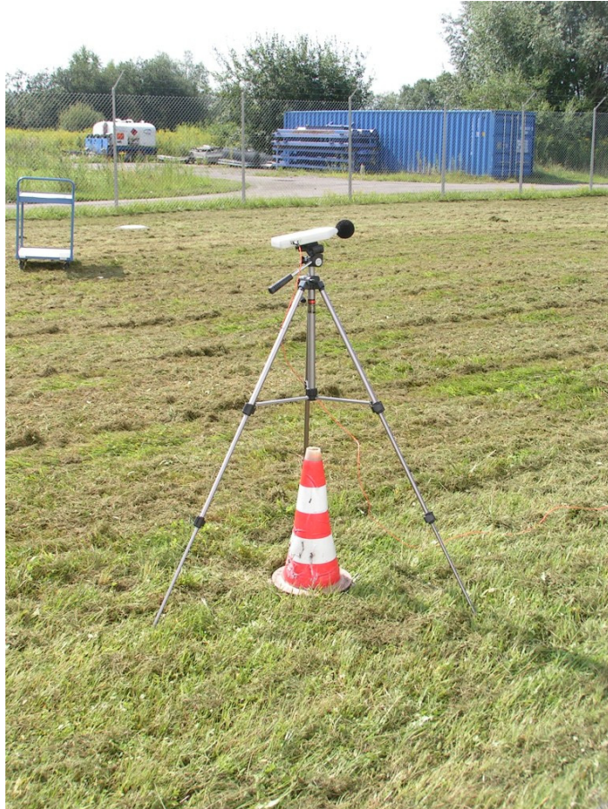
Bild 41 Mikrofon in Stativ-Anordnung in 1.20 m über Grund
