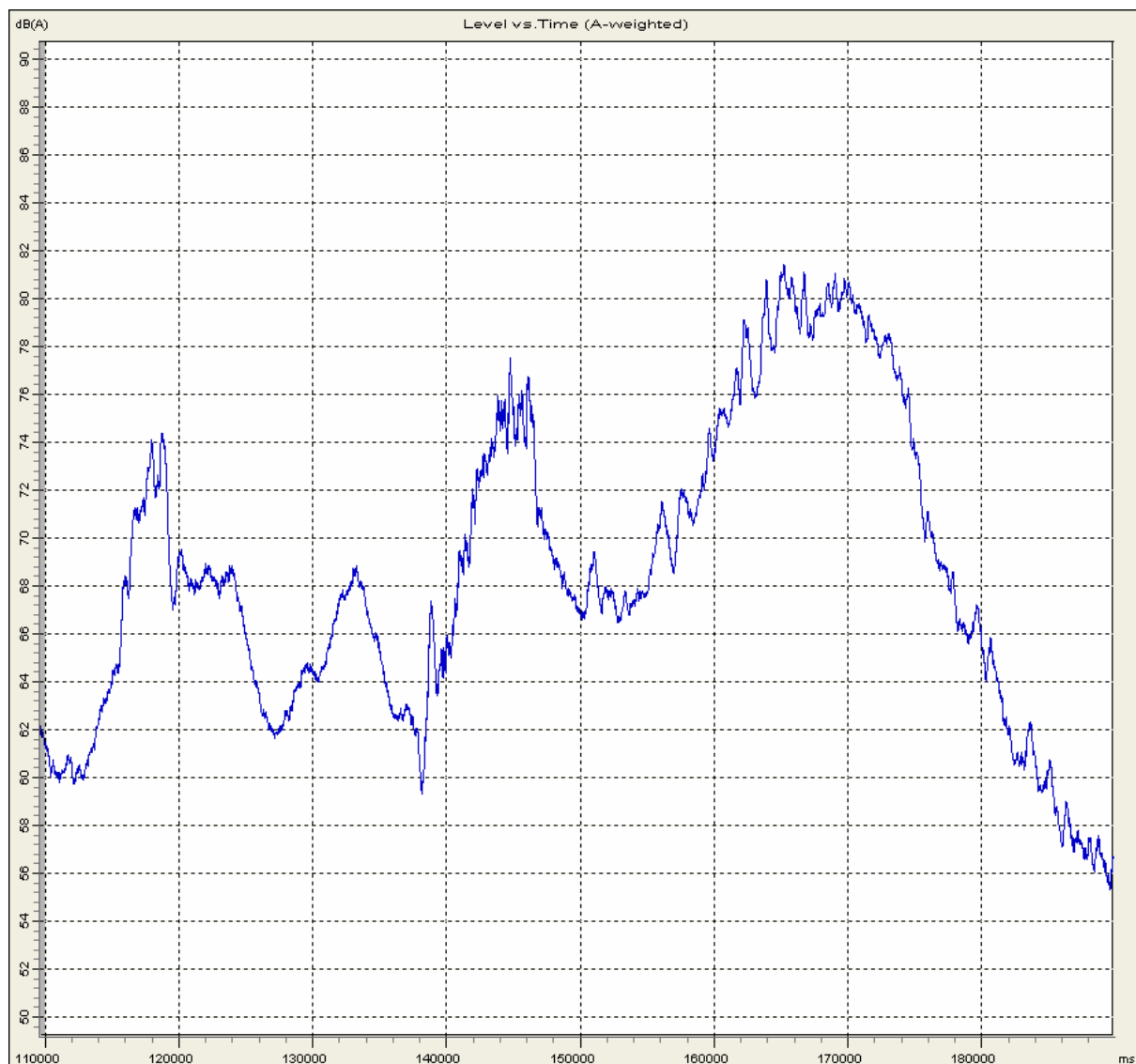
Bild 18 A-bewerteter Schallpegel eines Startvorganges mit Überflug Datei: N07_TO_00.wav Scaling: 60...90 dB Meßbereich: 50...100 dB ( \Delta dB = + 2.3 dB)
