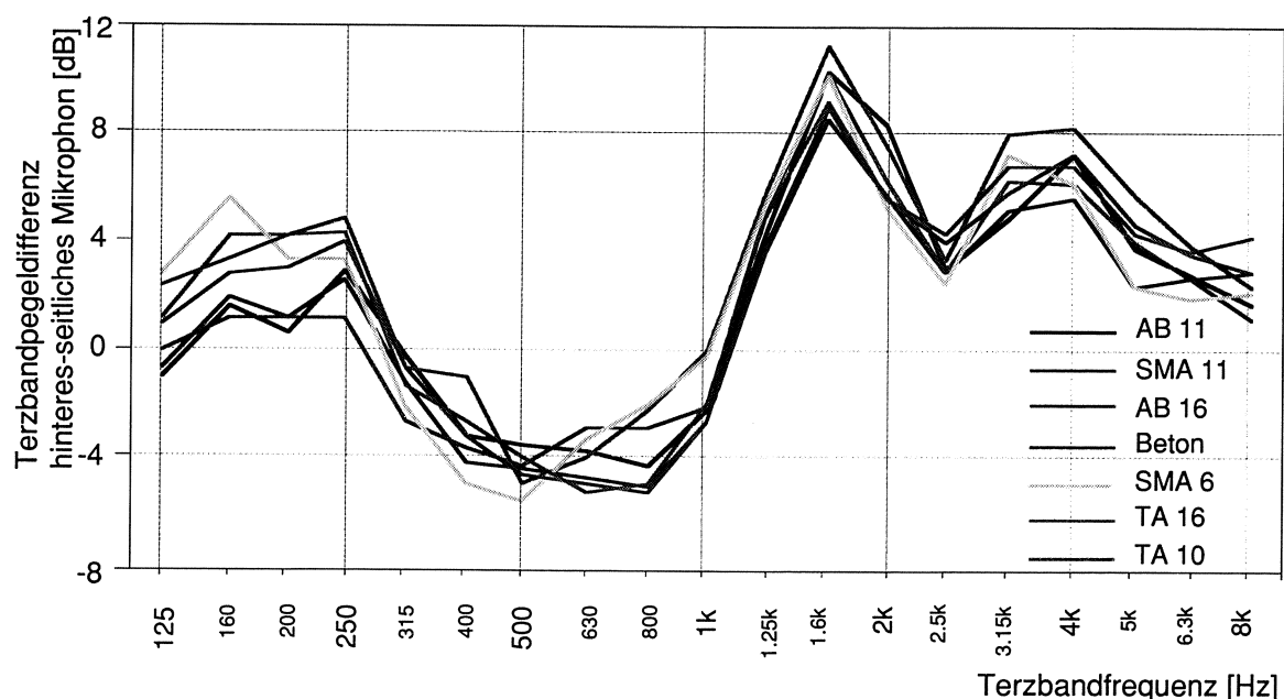
Abbildung 7.26: Differenz zwischen hinterem und seitlichem Mikrophon bei dichten Belägen der Kategorie A1 ( v = 80 \text{ km/h} ) Positive Werte bedeuten einen höheren Terzbandpegel des hinteren Mikrophons.
