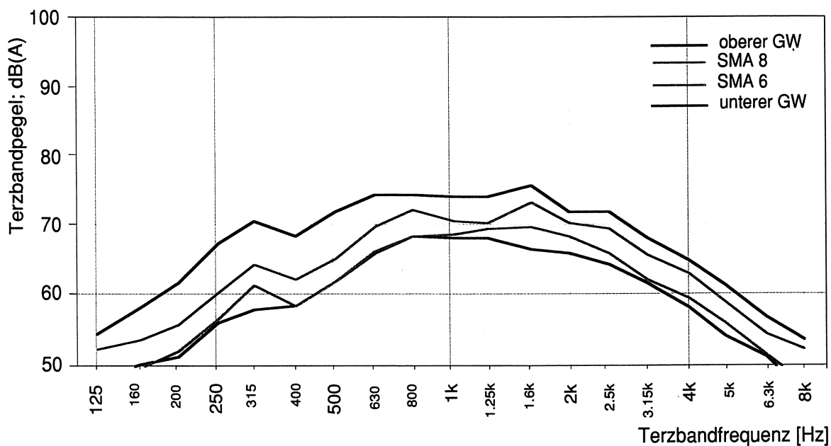
Abbildung 7.8: Terzbandanalysen bei 30 km/h, Beläge der Gruppe IV Der SMA 6 ist deutlich leiser als der SMA 8.
