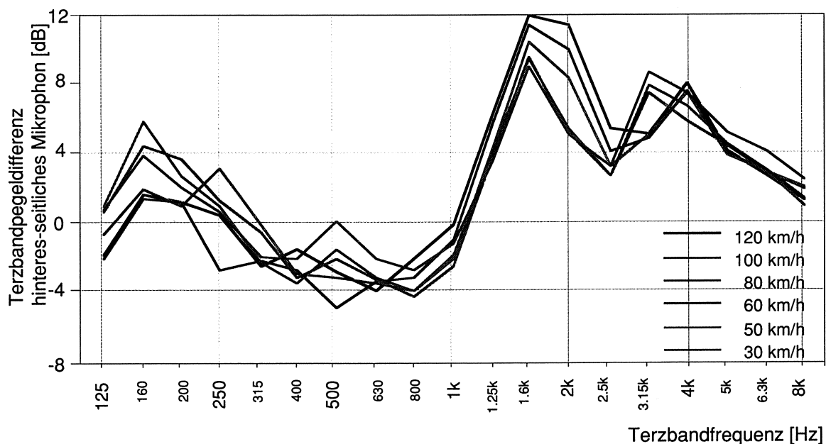
Abbildung 7.30: Terzbandpegeldifferenz zwischen hinterem und seitlichem Mikrophon bei AB 11 in Abhängigkeit der Geschwindigkeit
