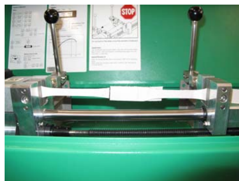
Abb. III.3.8 Empa-Prüfmuster Schweißnähte unterschiedlicher Qualität: Prüfmuster Nr. 4: Scherwiderstandsbestimmung (Zugversuch)
