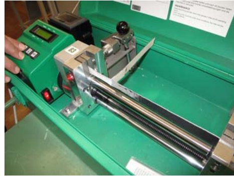
Abb. III.3.7 Empa-Prüfmuster Schweißnähte unterschiedlicher Qualität: Prüfmuster Nr. 4: Schälzugversuch
