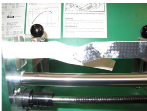
Abb. III.3.3 Empa-Prüfmuster Schweißnähte unterschiedlicher Qualität: Prüfmuster Nr. 2: Schälzugversuch
