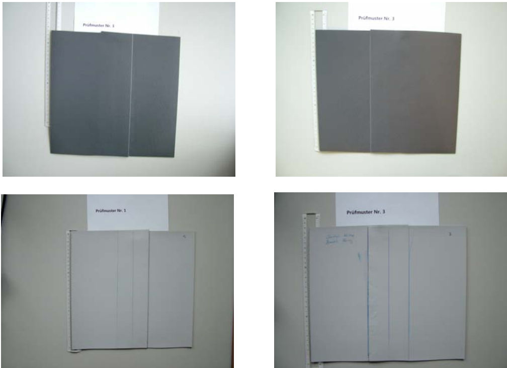
Abb. 4.2.4 Fotos der PVC-Schweissmuster für die Thermografie-Prüfung (links) Prüfmuster Nr. 1, (rechts) Prüfmuster Nr. 3, (oben) Seite Richtung Berg, (unten) Seite Richtung Gewölbe.
