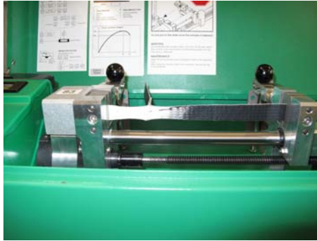
Abb. III.3.7 Empa-Prüfmuster Schweißnähte unterschiedlicher Qualität: Prüfmuster Nr. 4: Schälzugversuch
