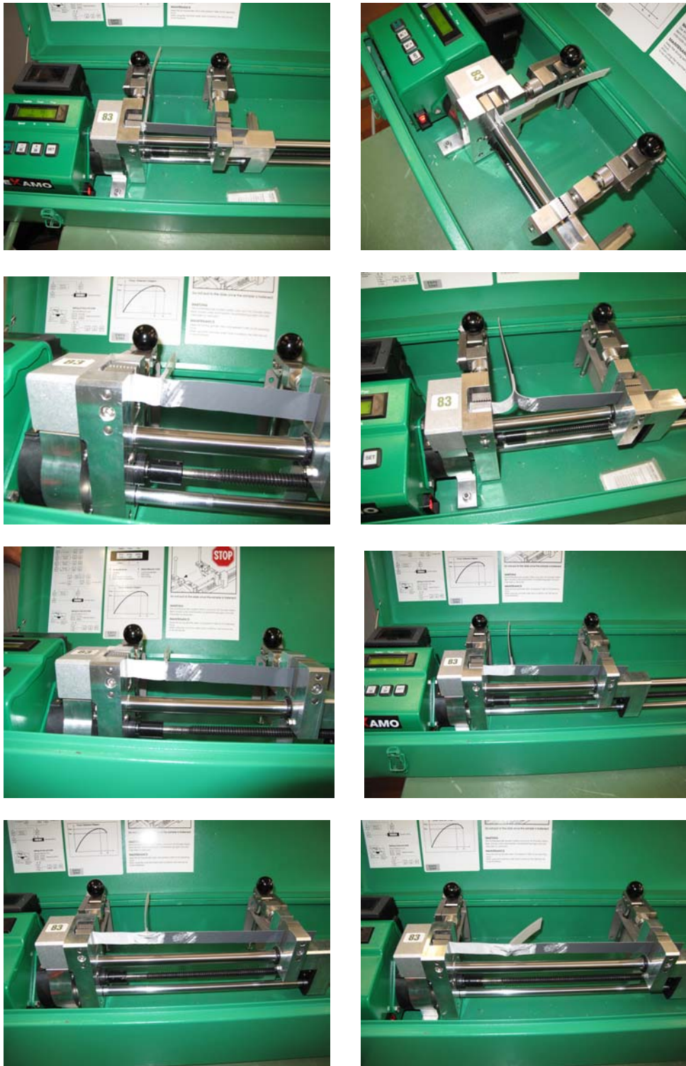
Abb. III.3.5 Empa-Prüfmuster Schweißnähte unterschiedlicher Qualität: Prüfmuster Nr. 3: Schälzugversuch
