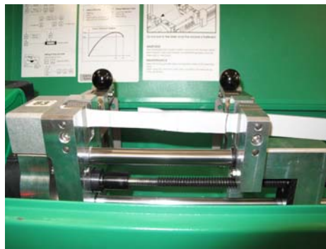
Abb. III.3.6 Empa-Prüfmuster Schweißnähte unterschiedlicher Qualität: Prüfmuster Nr. 3: Scherwiderstandsbestimmung (Zugversuch)
