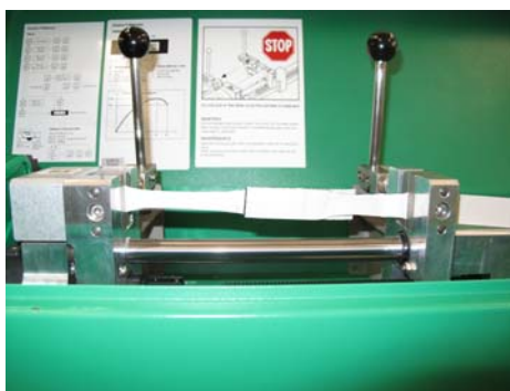
Abb. III.3.8 Empa-Prüfmuster Schweißnähte unterschiedlicher Qualität: Prüfmuster Nr. 4: Scherwiderstandsbestimmung (Zugversuch)
