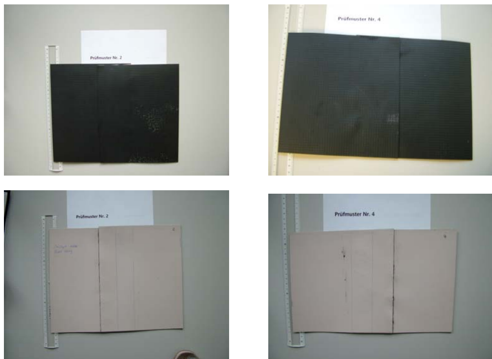
Abb. 4.2.1 Fotos der Polyethylen-Schweissmuster für die Thermografie-Prüfung (links) Prüfmuster Nr. 2, (rechts) Prüfmuster Nr. 4 (oben) Seite Richtung Berg, (unten) Seite Richtung Gewölbe.
