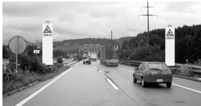
Abb. 2-9: Portalanordnung Signal „Baustelle“ auf gelben Tafeln
