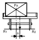
$R_1, R_2 = Load per wheel in t$
