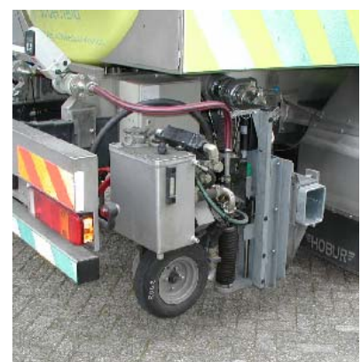
Abb. 16: ROAR, Messfahrzeug und Messvorrichtung mit ASTM-Reifen (Niederlande)
