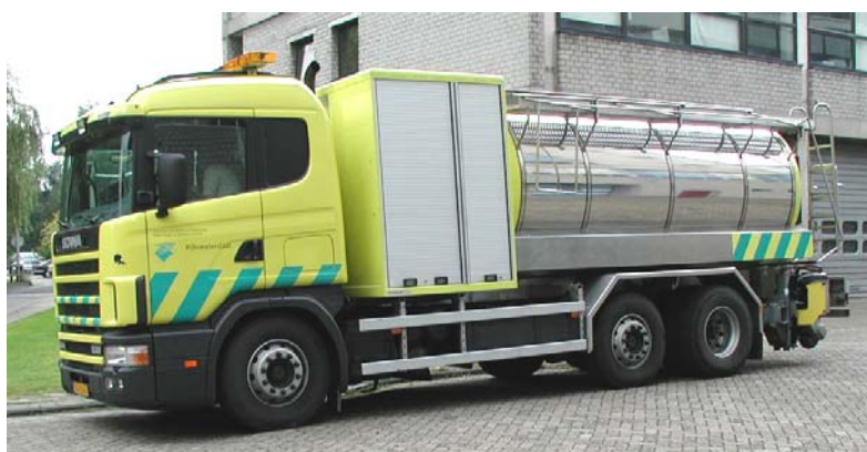
Abb. 16: ROAR, Messfahrzeug und Messvorrichtung mit ASTM-Reifen (Niederlande)
