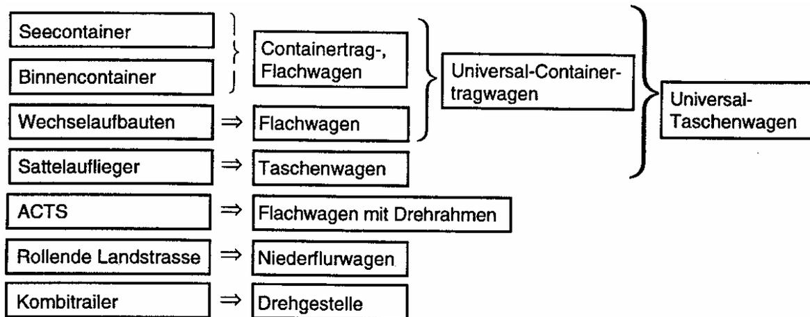
**Abbildung 8** Verwendung des Rollmaterials im kombinierten Verkehr
