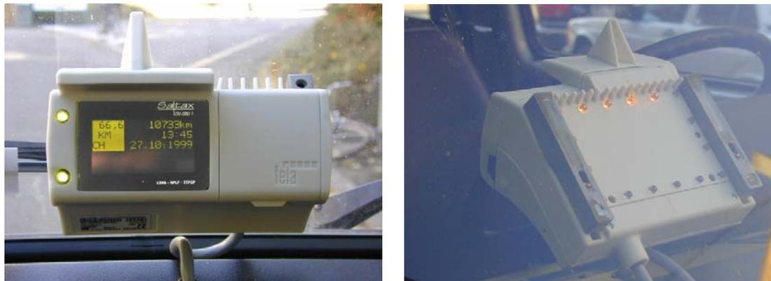
**Abbildung A - 2 LSVA Erfassungsgerät TRIPON® aus Sicht des Fahrers und von aussen**
