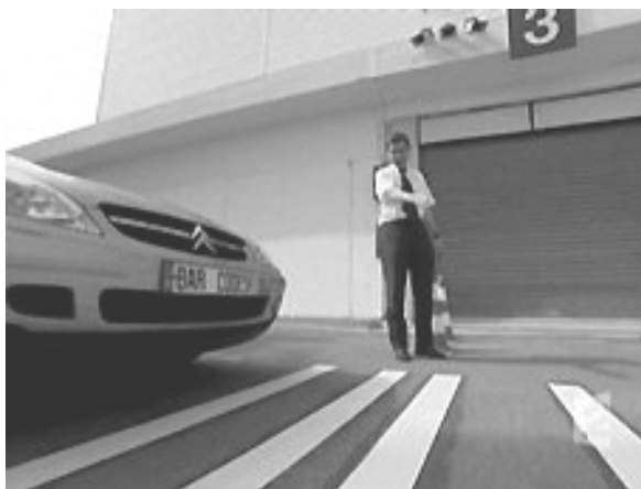
Abb. 5.7 Codemarkierungen zur Informationsübermittlung gemäss Peugeot [76]
