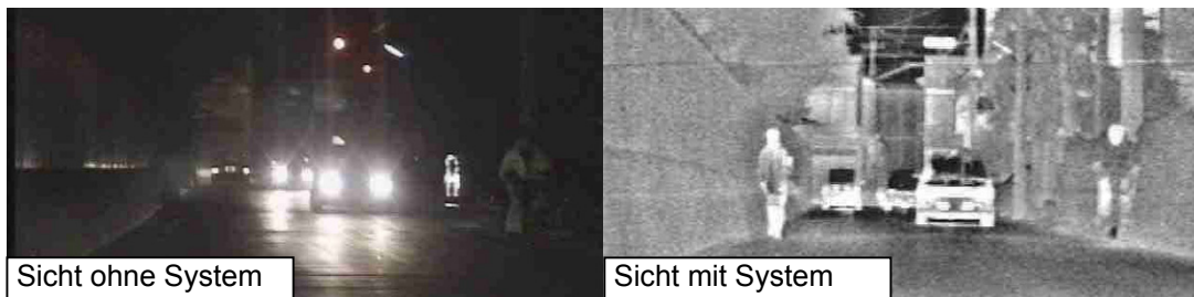
Abb. 5.3 Night Vision System, gemäss Honda [71]
