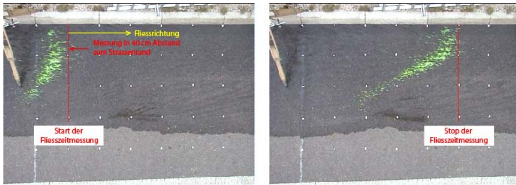
Abbildung 15: Ermittlung der Fließgeschwindigkeit an der Wasseroberfläche mit particle tracking beim Standort Mt Russelin bei einer Wassermenge von 24 l/s.
