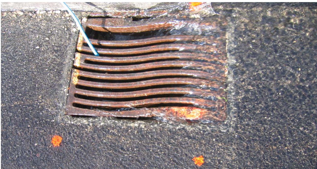
Abbildung 43: Aufnahme eines Einlaufschachtes während eines Versuches in Birmensdorf. Von der zur Verfügung stehenden Rostfläche wird in Fliessrichtung selbst bei grossen Durchflussmengen nur ein kleiner Teil beansprucht. Das Fassungsvermögen wird von den Anströmbedingungen und der Breite des Wasserlaufes bestimmt und kaum von der Schluckfähigkeit des Rostes und des Schachtes.
