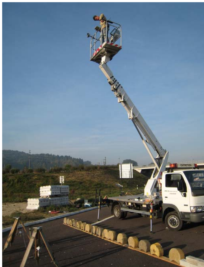
Abbildung 11: Positionierung der beiden Kameras senkrecht über dem Versuchsfeld
