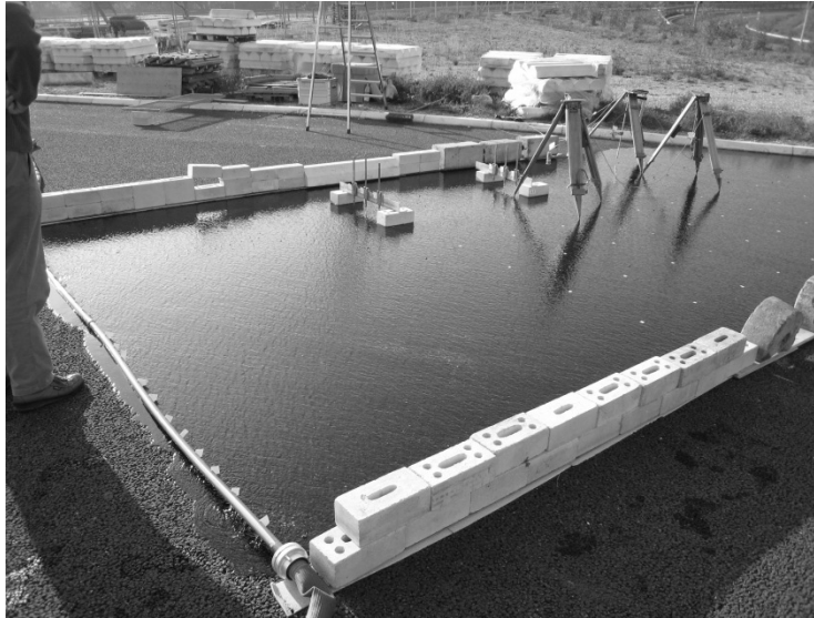
Abbildung 8: Versuchsaufbau zur Ermittlung der Wasserfilmdicke, Fließgeschwindigkeit und Anlaufzeiten für verschiedene Niederschlagsintensitäten in Delémont.
