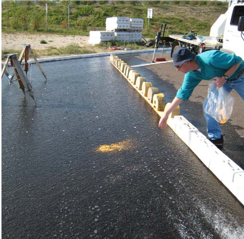
Abbildung 10: Eingabe der Papierpartikel während des Wasserfilmversuches in Delémont.
