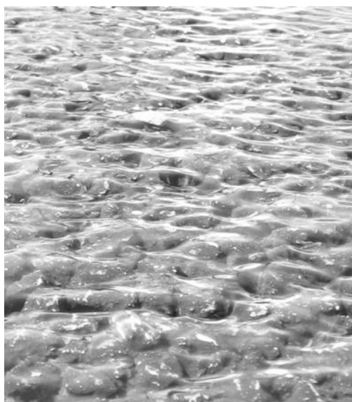
Abbildung 19: Wasserfilm auf der Strasse am Standort Delémont. Deutlich ist die unregelmässige Wasseroberfläche zu sehen.
