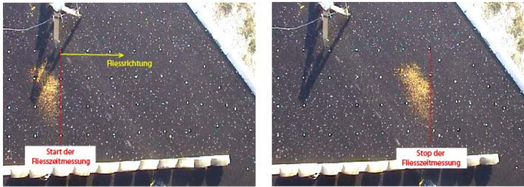
Abbildung 12: Ermittlung der Fließgeschwindigkeit der Wasseroberfläche auf der Strasse mit "particle tracking" in Delémont bei einer Wassermenge von 3.6 l/s.
