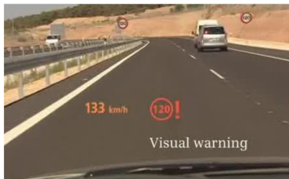
Abbildung 1: Das Geschwindigkeitswarnsystem von Siemens VDO. Der mittels automatischer Bildauswertung erkannte Geschwindigkeitswert wird neben dem aktuellen Geschwindigkeitswert mit einem sogenannten „Head-up Display“ auf die Windschutzscheibe projiziert, um vor einer Übertretung zu warnen.
