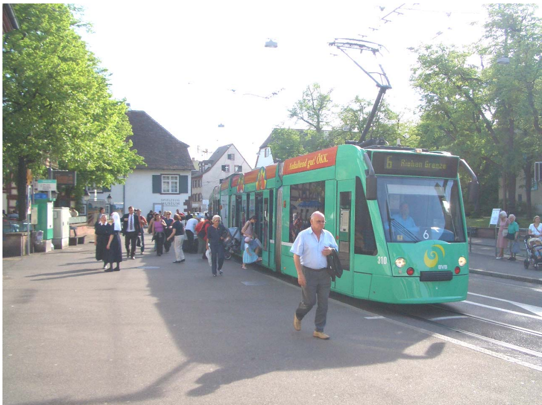
Abb.: Die Kaphaltestelle in Riehen verdeutlicht den komfortablen und sicheren Bereich für wartende bzw. ein-/aussteigende Fahrgäste.
