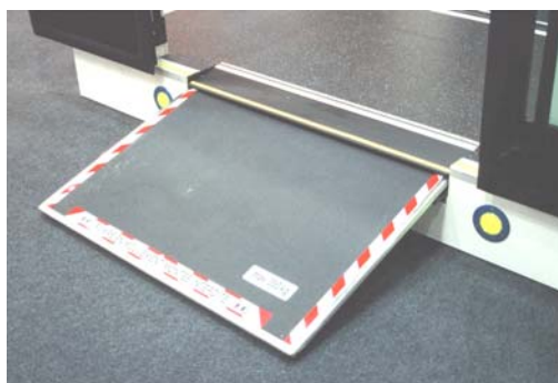
Modell einer elektrisch ausfahrbaren Tram - Rollstuhlrampe [Bildquelle: Schweizerische Fachstelle Behinderte und öffentlicher Verkehr]
