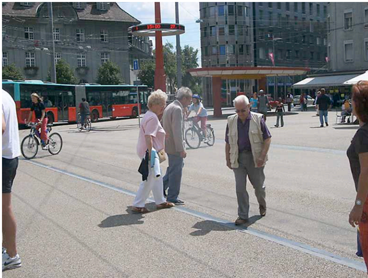
Abbildung 19 Zentralplatz Biel, Begegnungszone: Die Fahrbahn ist durch einen deutlich ertastbaren schrägen Randstein von der Fussgängerfläche getrennt
