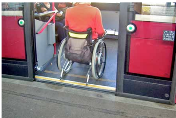
Abbildung 33 Niveaugleicher und somit autonomer Einstieg beim Bus
