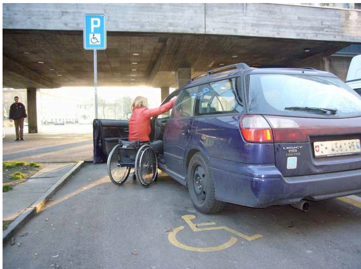
Abbildung 32 Behindertenparkfeld mit Markierung und Signalisation
