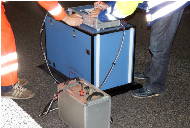
Abb. XI.27 Messapparatur zur Bestimmung der Reflexion der Fahrbahn
