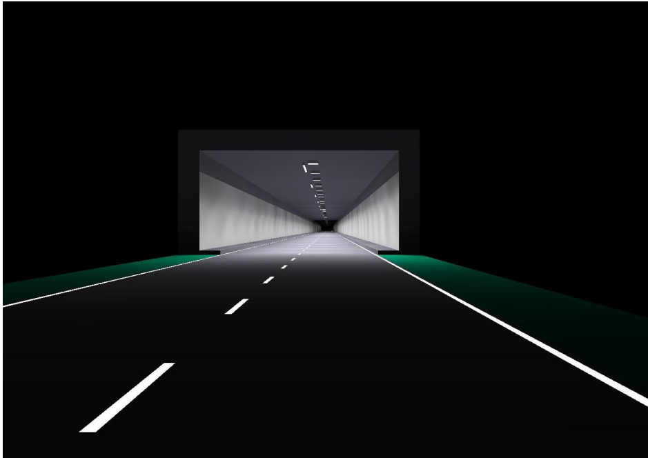
Abb. 5.10 Lichtraumprofil 2-streifiger Tunnel
