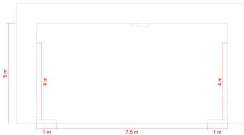
Abb. 5.11 Abmessung des Lichtraumprofils
