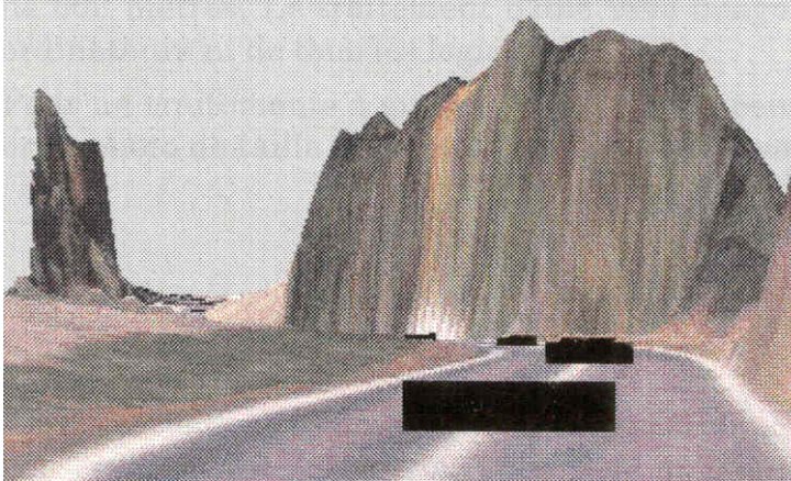
Figure 25 : Visualisation d'obstacles virtuels pour le calcul des distances de visibilité par photogrammétrie [23]
