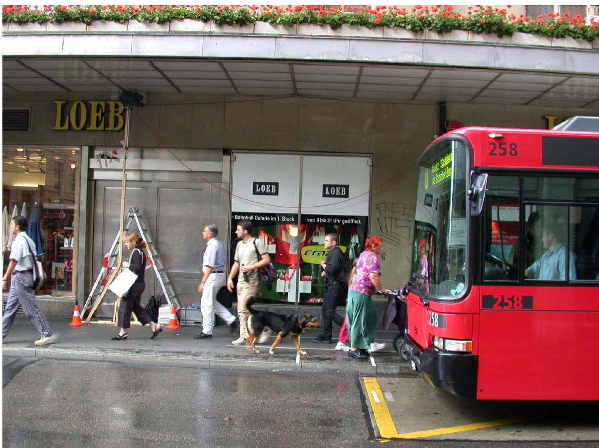
Die Messeinrichtung bestand aus einer VHS-Kamera, die auf einem vier Meter hohem Holzgerüst montiert wurde. Der Fokus wurde auf die zweite Bustür gerichtet. In der Absicht den Raumbedarf der beteiligten Personen abschätzen zu können, wurde entlang der ganzen Buslänge und auf der ganzen Haltestellenbereite mit weissem Malerband ein Gitternetz mit einer Maschenweite von einem Meter markiert (siehe Abbildung 1).
