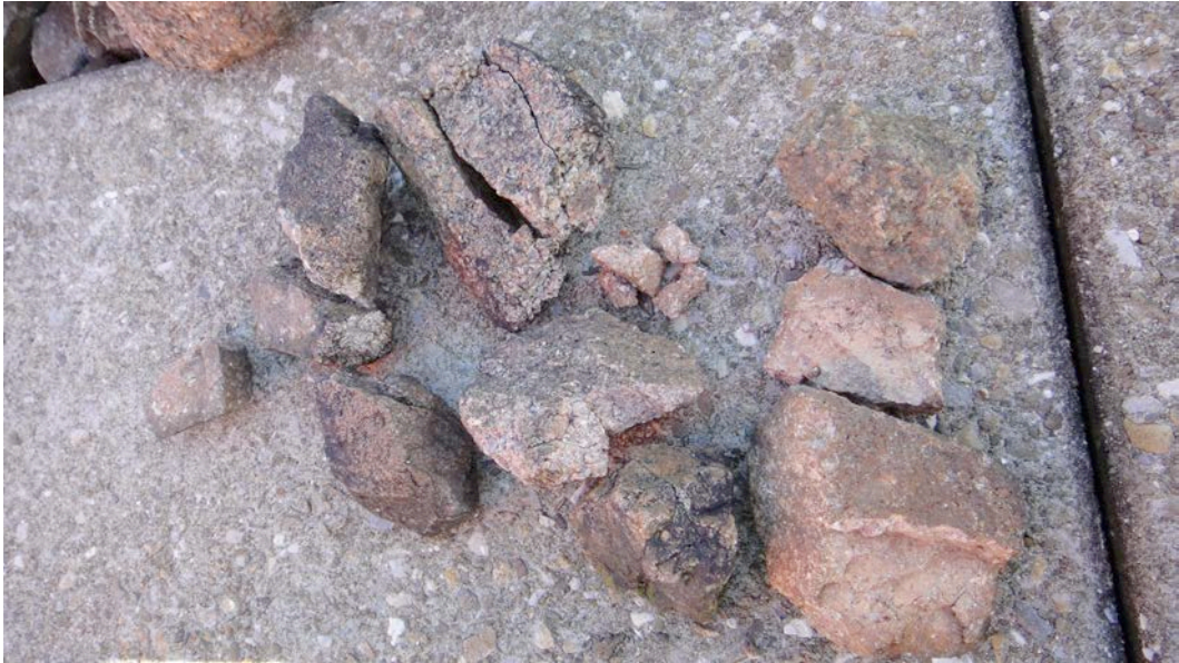
Fig. 133.09 Exemple de grains de ballast pour voies ferrées altérés provenant d'une voie nécessitant un renouvellement prématuré du ballast dû à l'altération des granulats composés de granite chloritisé et kaolinisé. Examens de la voie et photographie M. Erich Würsch, CFF – Infrastructure.
