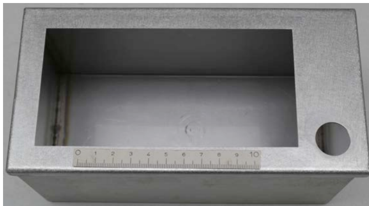
Fig. 5.4 Type de bac métallique permettant un meilleur transfert entre le liquide du thermocryostat et la solution de sulfate de sodium. L'orifice dans le couvercle permet l'introduction d'un agitateur.
