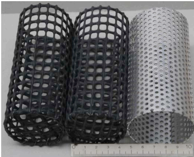
Fig. 5.8 Systèmes de conteneurs pour les éprouvettes composées de grains de ballast et de gravillons. Le type en métal est une ébauche, mais n'a pas été utilisé.
