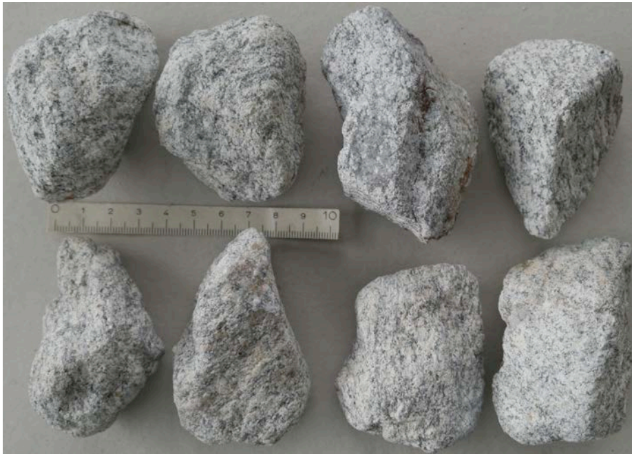
Fig. 12.3 grains de ballast composés de gneiss fortement kaolinisé avant l'essai.
