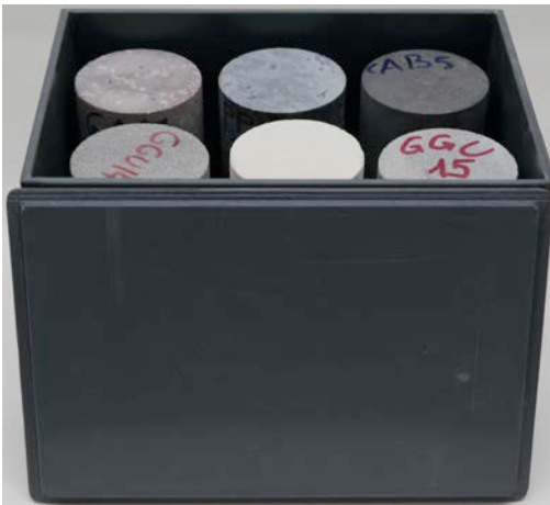
Fig. 5.3 Type de bac en plastique utilisé pour placer les éprouvettes et la solution dans le thermocryostat.
