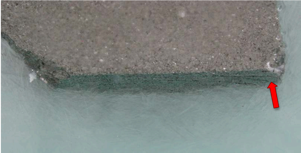
Fig. 4.1 Essai exploratoire effectué sur des cubes de Molasse Bernoise. L'arête des cubes de molasse est de 7 cm. Les cristaux de forme aciculaire de sulfate de sodium décahydrate sont bien visibles dans la solution. Les dégradations sous forme de fissurations apparaissent sur le bord de l'éprouvette (exemple indiqué par une flèche) comme dans l'essai de Quervain.
