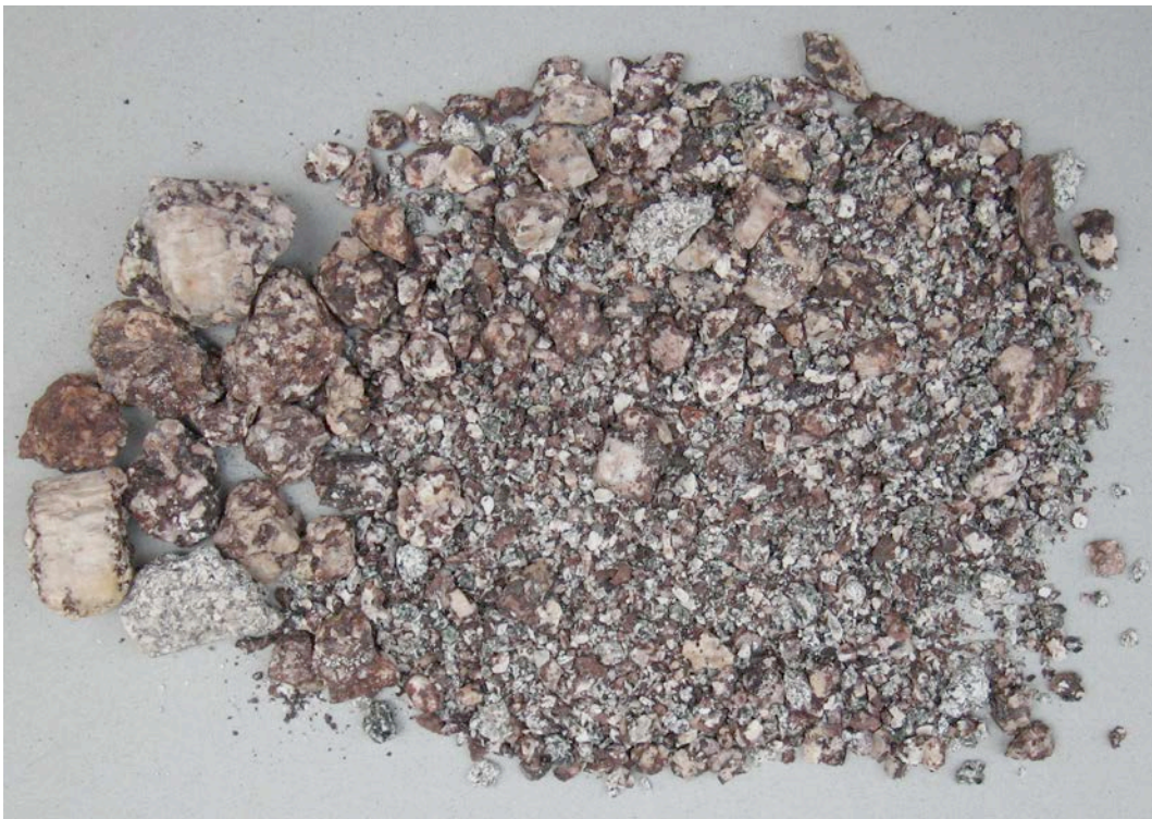
Fig. 12.2 État des gravillons gélifs après 4 cycles de l'essai. Il s'agissait du premier système comprenant un bac de réaction et une solution à 25% de sulfate de sodium. Les contraintes de température ont été définies en dessous du domaine de stabilité de la phase métastable et en dessous du domaine de stabilité de la thenardite. Les gravillons durables se sont montrés insensibles à l'essai alors que les gravillons sensibles aux intempéries ont été totalement dégradés.
