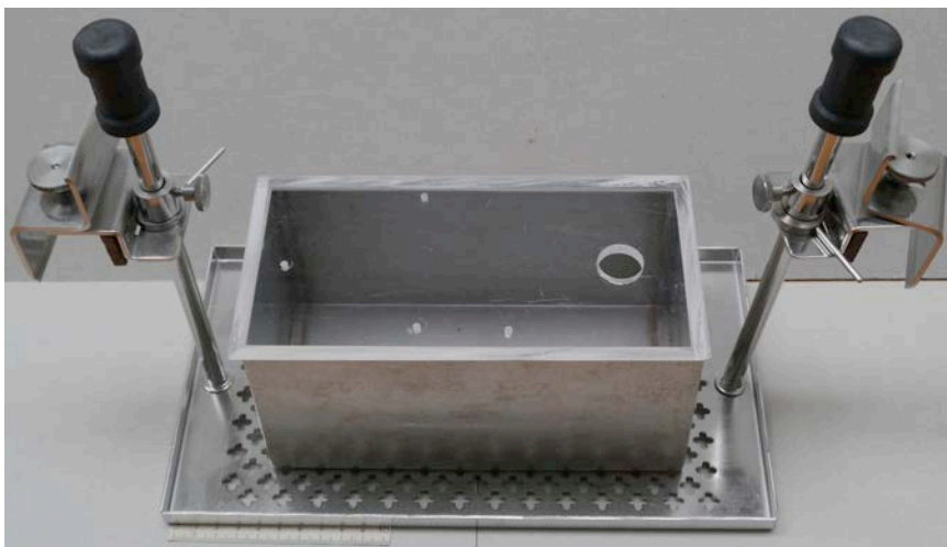
Fig. 5.1 Dispositif permettant de plonger les bacs contenant la solution et les éprouvettes dans la cuvette du thermocryostat. Des emplacements pour les thermoéléments et l'agitateur ont été aménagés dans le couvercle.
