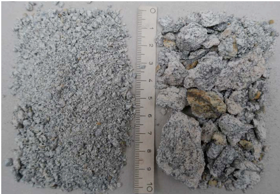
Fig. 12.4 grains de ballast composés de gneiss kaolinisé après 6 cycles du nouvel essai dans le réacteur avec une solution à 20% de \text{Na}_2\text{SO}_4 .
