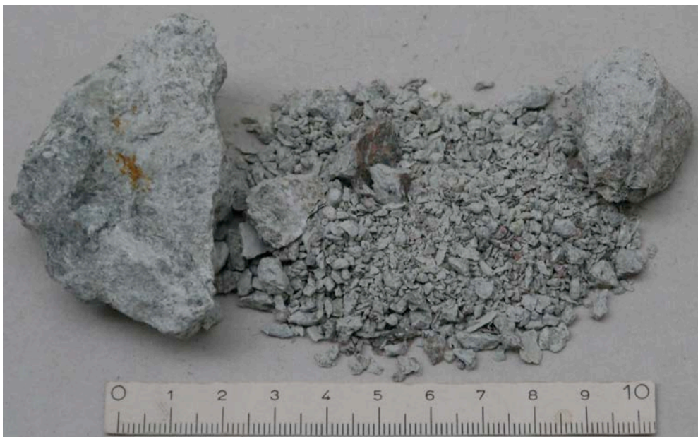
Fig. 12.10 grains de ballast composés de volcanite transformée hydrothermalement après 9 cycles du nouvel essai dans le réacteur avec une solution à 25% de \text{Na}_2\text{SO}_4 .
