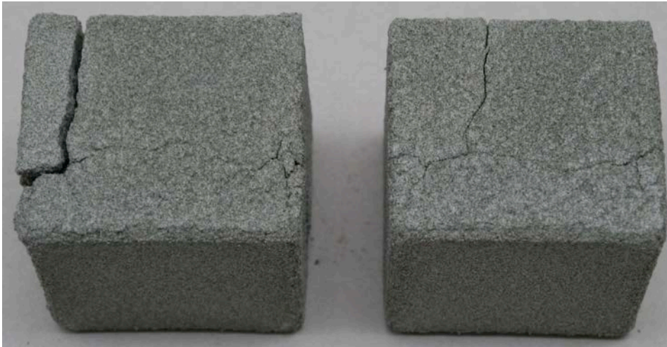
Fig. 10.9 Cubes de molasse bernoise après 2 cycles de l'essai de cristallisation selon la méthode de F. de Quervain avec 10% de sulfate de sodium. Les dégradations sont importantes, mais les cubes sont encore relativement intacts.
