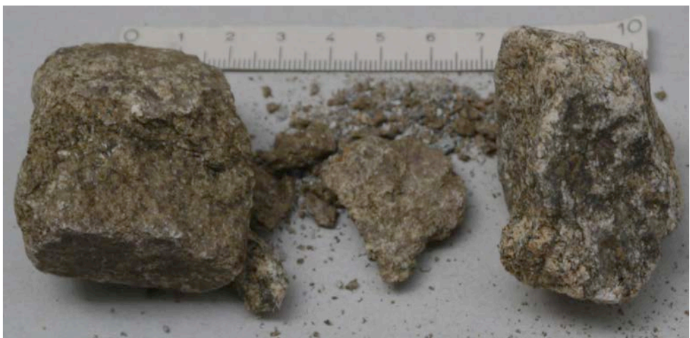
Fig. 12.9 grains de ballast composés de gneiss altéré après 9 cycles du nouvel essai dans le réacteur avec une solution à 25% de \text{Na}_2\text{SO}_4 .
