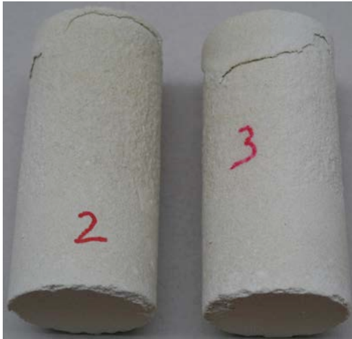
Fig. 9.17 Tuffeau blanc ou pierre de Bourré après 1 cycle de l'essai de cristallisation. Les dégradations sous forme de pelure d'oignon apparaissent similaires à celles observées sur les monuments historiques.
