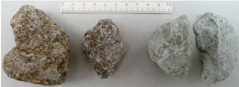
Fig. 12.8 exemples grains de ballast composés de gneiss altéré partiellement (à gauche) et de volcanite transformée hydrothermalement (à droite). L'altération et la transformation ne sont pas homogènes.
