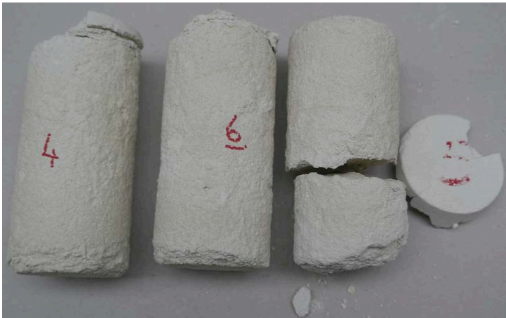
Fig. 9.18 : tuffeau blanc ou pierre de Bourré après 2 cycles de l'essai de cristallisation. Imbibé d'eau et seulement après deux cycles, le tuffeau ne présente plus de résistance significative aux contraintes mécaniques. Ce comportement particulier permet d'expliquer certaines formes de dégradation observées sur les parties exposées aux intempéries des ouvrages historiques. Ce type de dégradation n'avait pas été examiné lors de l'étude réalisée par F. de Quervain. Ce comportement particulier du tuffeau blanc montre l'importance d'un essai de résistance pour la roche humide pour certaines lithologies.
