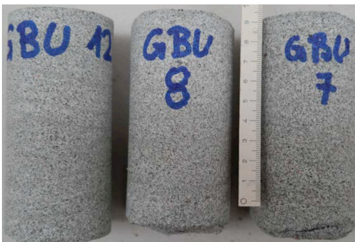
Fig. 9.13 Grès granitique à grain grossier (GBU) après 7, 8 et 12 cycles.
