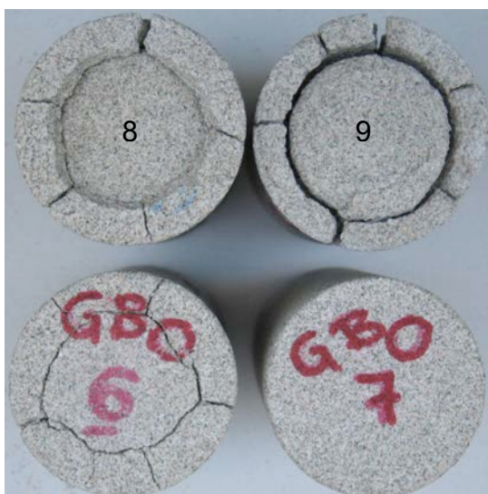
Fig. 9.5 Grès granitique à grain moyen (GBO) après 6, 7, 8 et 9 cycles.
