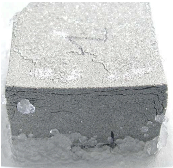
Fig. 4.2 Éprouvette composée d'un cube de molasse bernoise de 7 cm d'arête. Essai exploratoire avec une solution de sulfate de sodium ayant été soumise à des cycles de variation de température induisant la cristallisation de cristaux hydratés de sulfate de sodium. Des cristaux de sulfate de sodium hydraté sont présents autour de l'éprouvette. Le reste de solution a été éliminé pour permettre la photographie. Les dégradations sous forme de pelure d'oignon (fissures concentriques) apparaissent similaires à celles observées lors de l'essai classique de F. de Quervain.
