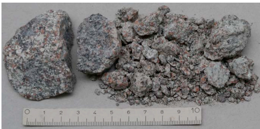
Fig. 12.7 grains de ballast composés de granite chloritisé et partiellement kaolinisé après 9 cycles du nouvel essai dans le réacteur avec une solution à 25% de \text{Na}_2\text{SO}_4 . La durée de l'essai est d'environ 2 jours et demi seulement.
