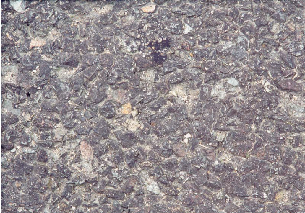
Fig. 133.7 Exemple d'altération de granulats composés de volcanite transformée hydrothermalement dans un revêtement de type MR dans une autoroute en Suisse. Des problèmes de glissance dus à la destruction d'une partie des granulats ont nécessité un remplacement prématuré du revêtement.
