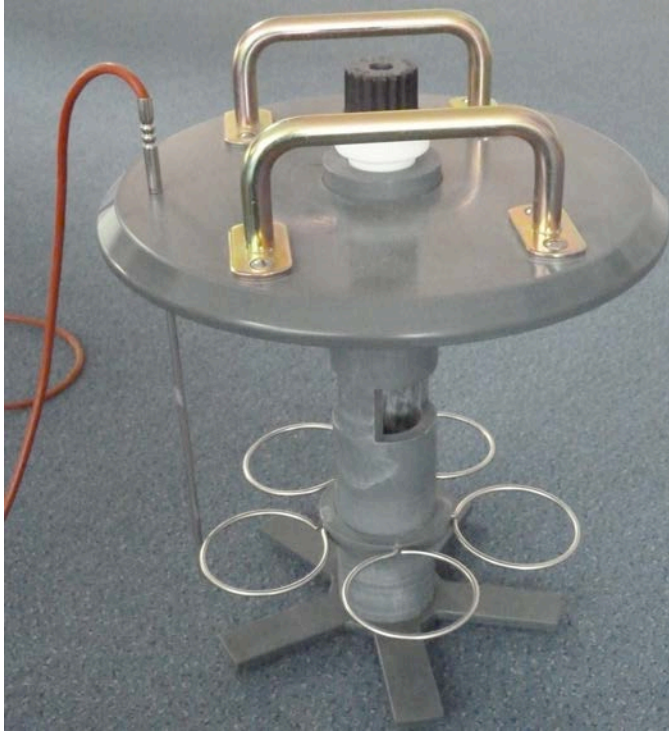
Fig. 5.7 Système de support et de fixation pour les éprouvettes cylindriques dans le réacteur. Ce système de support a été développé et réalisé par M. Jean-Marc Terraz du département de mécanique de l'EPFL.
