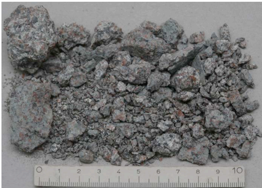
Fig. 12.6 grains de ballast composés de granite chloritisé et partiellement kaolinisé après 9 cycles seulement du nouvel essai dans le réacteur avec une solution à 25% de \text{Na}_2\text{SO}_4 . La durée de l'essai est d'environ 2 jours et demi seulement.
