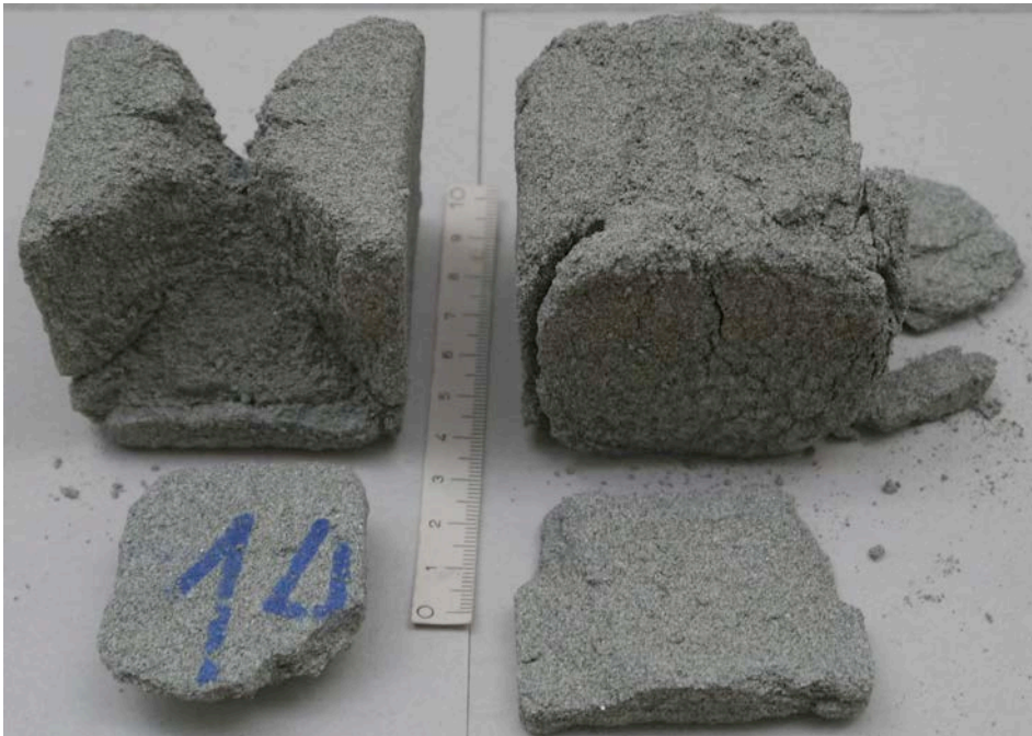
Fig. 10.2 Cubes de molasse bernoise après 2 cycles de l'essai de cristallisation selon la norme EN 12 371 avec 14% de sulfate de sodium. Les cubes sont totalement détruits et aucune mesure mécanique ne peut plus être réalisée.
