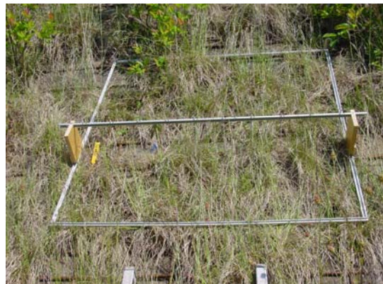
Abb. 2.8 Zählrahmen mit Zählbalken
