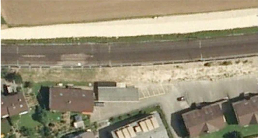
**Abb. 41** Bahnstrecke bei Gelterkinden (BL). Für den Bau der LSW auf der oben liegenden Böschungsseite wurde eine Zufahrt aufgeschüttet. Die Böschung wird im Zuge des Baus komplett zerstört werden.
