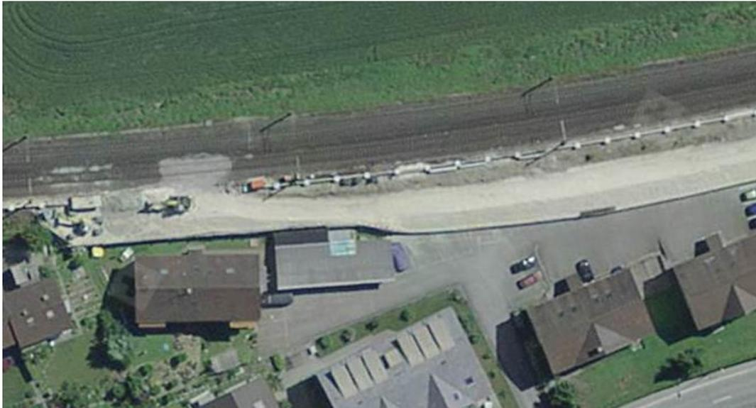
**Abb. 40** Bahnstrecke bei Gelterkinden (BL). Auf der unten liegenden Böschungsseite wird eine LSW gebaut. Die ehemalige Böschung ist komplett zerstört.
