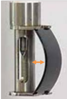
Abb. 2 Biegung des beschichteten Prüfblechs
