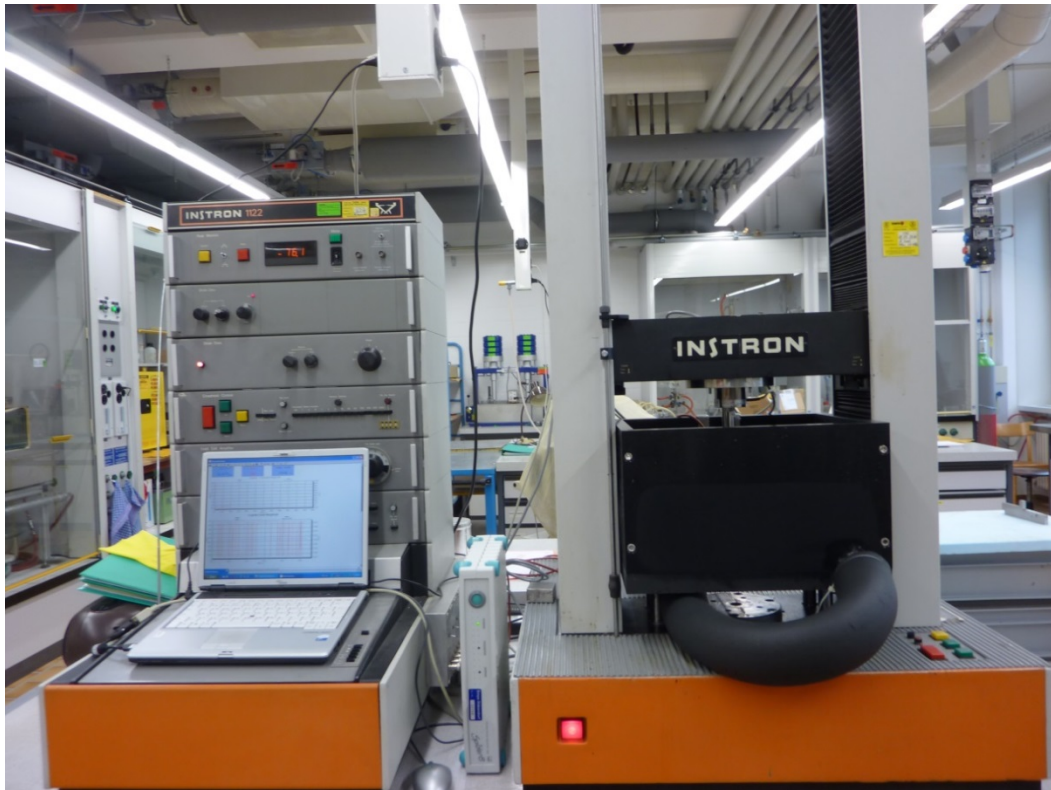
Abb. 4 Prüfmaschine (rechts) mit altem Steuerschrank und neuer Messsoftware (Laptop)
