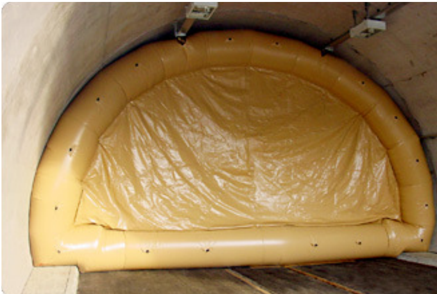
Abb. 2.10: Aufgeblasener „Tunnel plug“ der Firma Lindstrand. Vorrichtungen wurden beidseitig des Brandherdes, im Abstand von 30 und 60 m, installiert.
