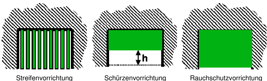
Abb. 4.1: Arten von flexiblen Vorrichtungen (Prinzipskizzen).
