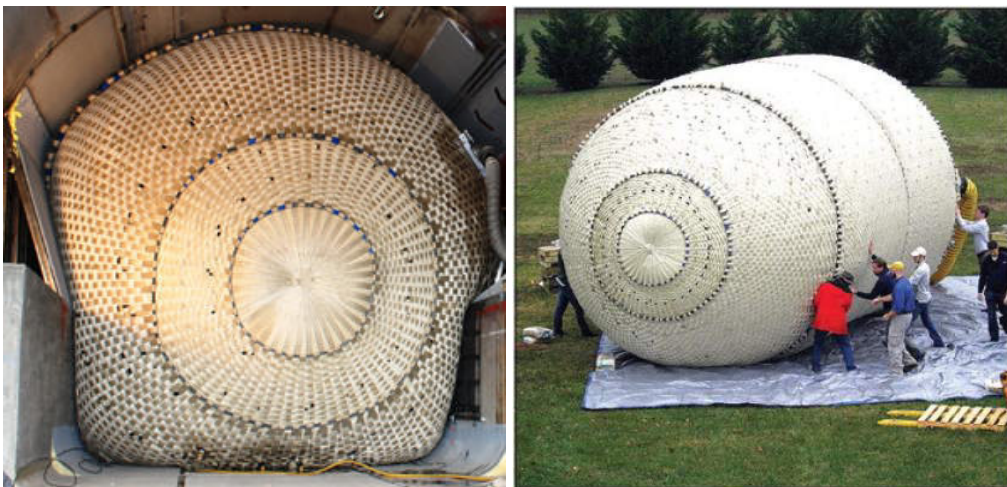
Abb. 2.13: Prototyp des aufblasbaren Tunnel Plugs zur Verhinderung von Überschwemmungen.
