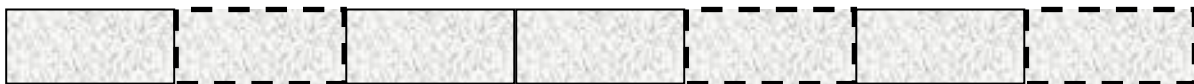
Abbildung 1: Beispielhafte Festlegung von Untersuchungsflächen an 7 Tunnelwandelementen (à 60 m 2 ), die im Wochenrhythmus hergestellt wurden; die gestrichelt umrandeten Flächen stellen die gemäss o.g. Kriterien festgelegten Untersuchungsflächen dar
