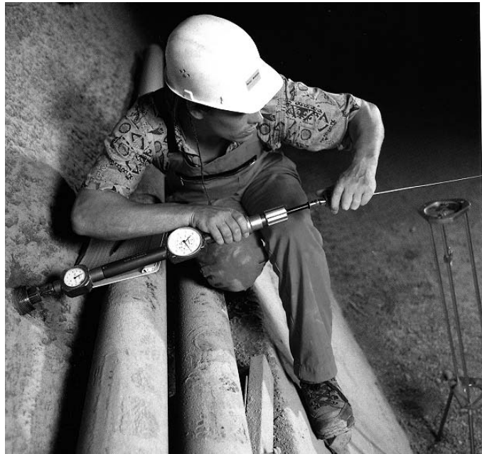
Bild 7-1 Konvergenzmessung hoher Präzision mit dem Distometer zur Überwachung des Langzeitverhaltens von Untertagbauten (Foto Solexperts, Schwerzenbach)
