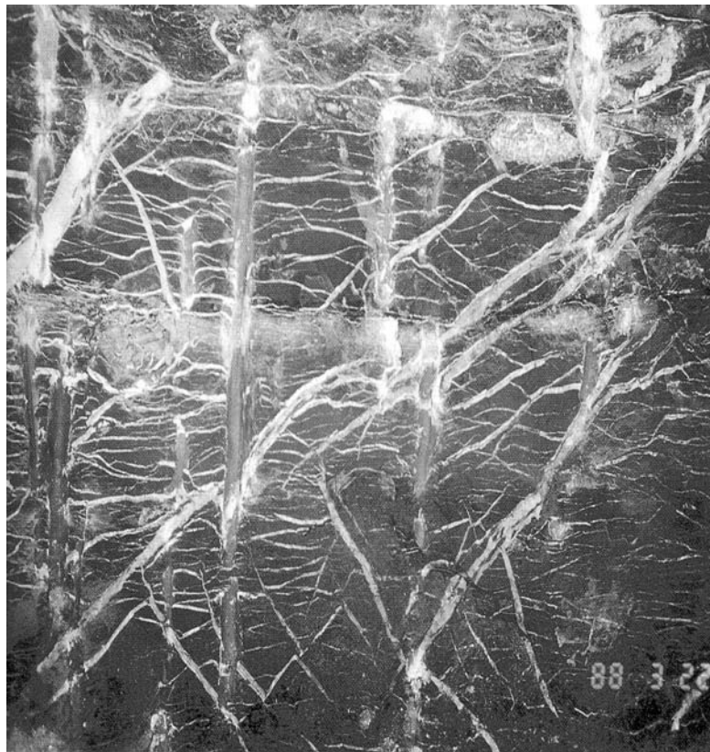
Bild 3-38 Untere Bunte Estheriensichten: Stark zerlegter, mit Fasergips verheilter Tonstein mit Anhydritadern in der Nähe des Anhydritspiegels (Berner, 1991)
