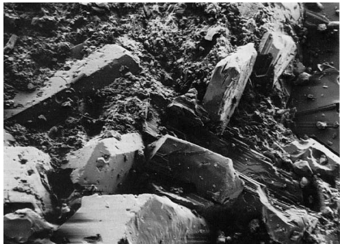
Bild 3-33 Aufnahme mit dem Rasterelektronenmikroskop: Aus rotem Anhydrit entstandener Gips mit teilweise idiomorphen Kristallflächen, Vergrösserung etwa 40 fach (Berner, 1991)
