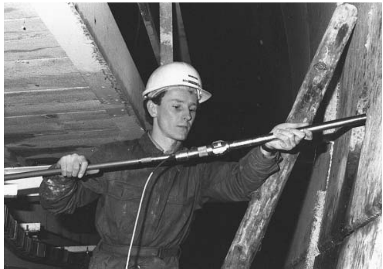
Bild 7-2 Gleitmikrometer: Messung des Dehnungsprofils entlang einer subhorizontalen Bohrung im Gebirge mit (v.l.n.r) Messgestänge, Messkopf mit Kabelanschluss, Gleitmikrometersonde (Foto Solexperts, Schwerzenbach)
