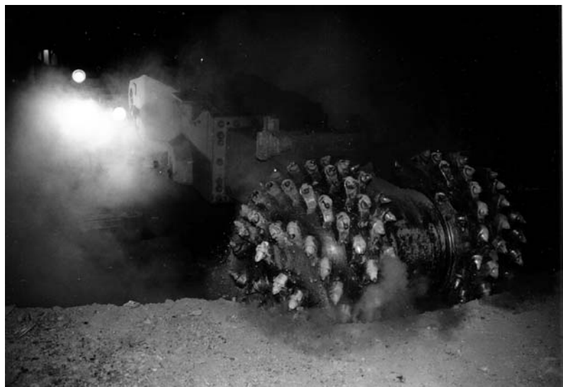
Bild 6-14 Staubentwicklung beim Lösen des Gesteins mit einer Teilschnittmaschine (Foto IGT, ETHZ)
