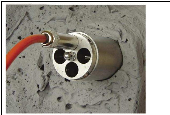
Abb. 3.26 Rockmeter RME der Firma Huggenberger AG.
