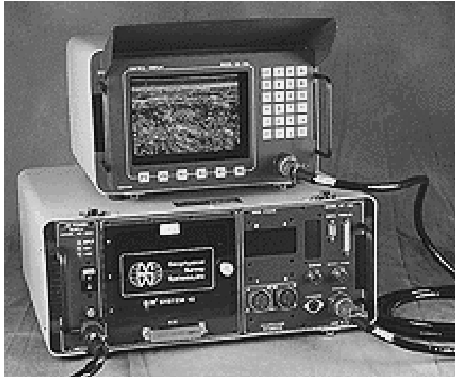
Abbildung 3.2.1: GSSI SIR-10A System
