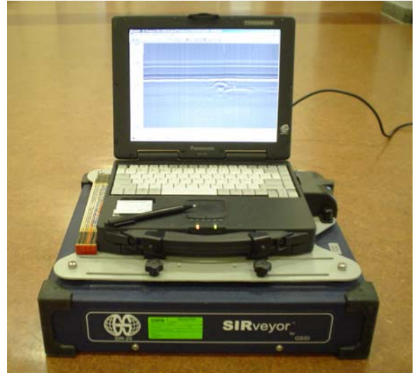
Abbildung 3.2.2: GSSI SIR-20 System
