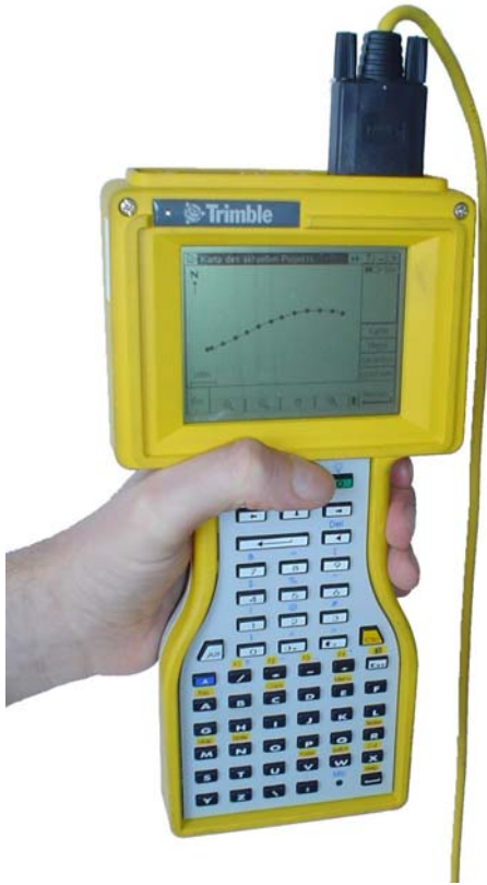
Abbildung 3.6.3: Controller mit Messlinie, Felsenauviadukt
