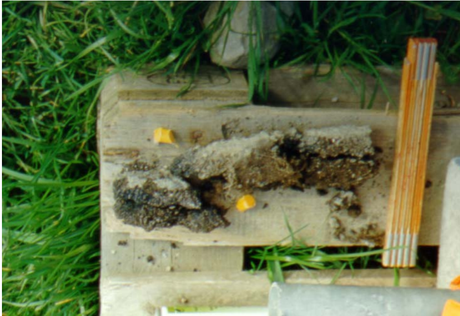
Abbildung 10.1.13: Belagsstück mit zerbröselter Schutzschicht AB11
