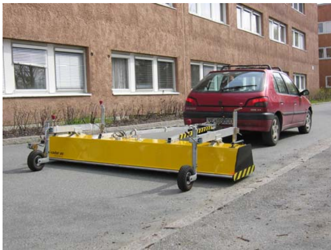
Abbildung 3.8.1: Antennenarray, Photo 3d-Radar AS, Norway
