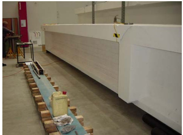
Abbildung 1.1.6: Längsträger vom Viadotto sopra le Cantine
