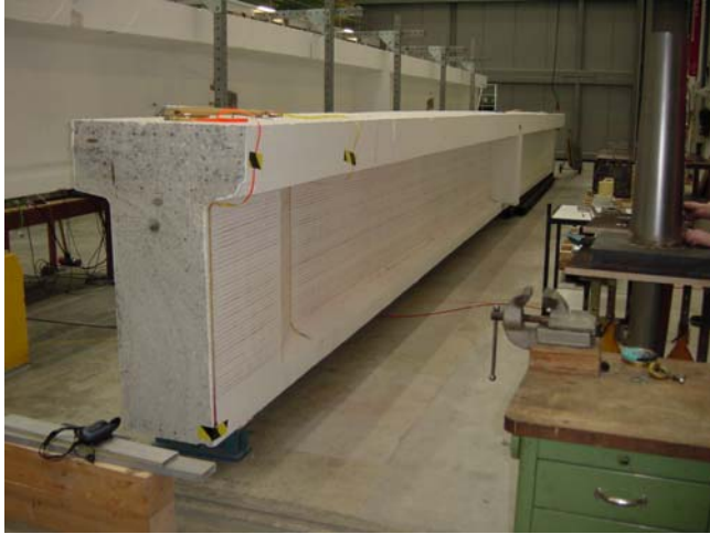
Abbildung 5.8.1: Längsträger vom Viadotto sopra le Cantine
