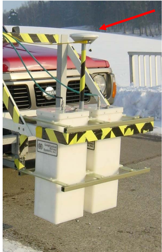
Abbildung 3.6.6: GPS-Antenne auf Fahrzeug (roter Pfeil)
