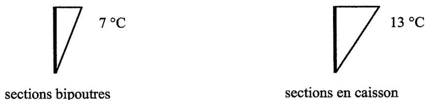
*Figure 53 - Gradient de température maximal dans la dalle pour les sections bipoutres et en caisson.*
