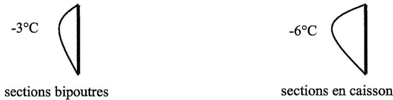
**Figure 54 - Composante non linéaire maximale de la température dans la dalle.**
