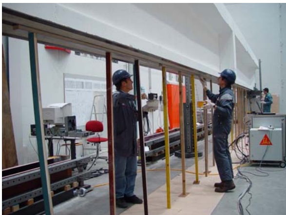
Abbildung 81: Träger 2, wegen der Durchbiegung des Trägers nach oben wurden die CFK-Lamellen unterstützt
