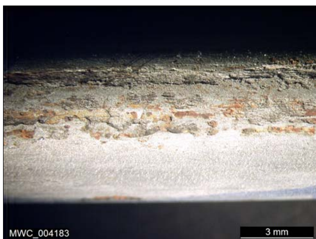
Abbildung 17: Drahtoberfläche nach teilweiser chemischer Entfernung der axial verlaufenden Rostkruste, deutlich sichtbar der Materialabtrag entlang der Rostkruste (Draht aus Sondierstelle 1)
