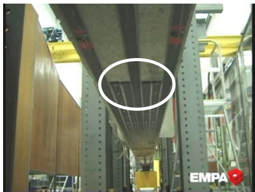
Abbildung 121: Beginn der Ablösung der kurzen Lamellen
