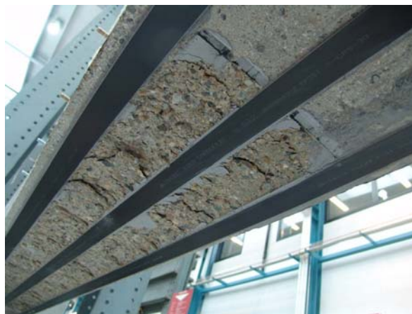
Abbildung 124: Bruchfläche am Ende der kurzen CFK-Lamellen
