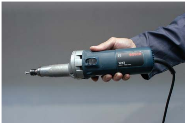
Abbildung 36: Boschschleifer mit einem Kugelhartmetallfrässtift zum Durchtrennen der Drähte
