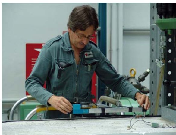
Abbildung 67: Deformetermessung an Trägeroberseite
