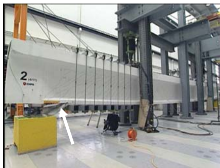
Abbildung 104: Träger 2 während ablösen des Endes der Lamellen
