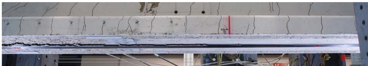
Abbildung 127: Am Träger 5 verbliebene Lamelle nach Versuch, Übergang zwischen delaminierter Zone zur Zone mit Verbund
