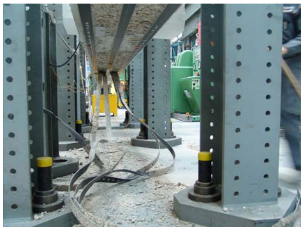
Abbildung 123: Delaminierte kurze CFK-Lamellen am Ende der Phase 5
