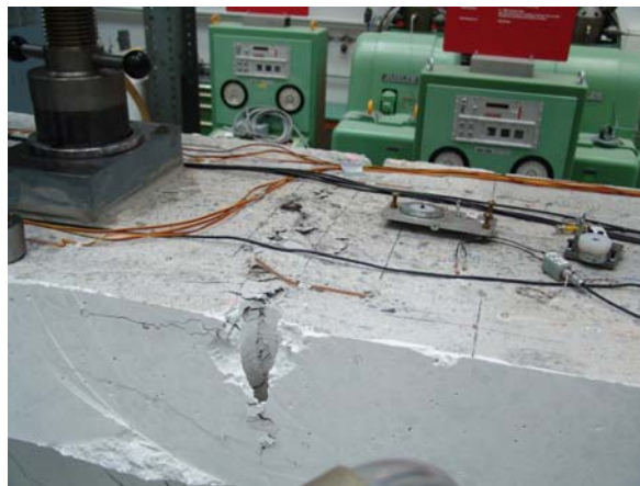
Abbildung 100: Träger 3 nach Bruch, Betonstauchung an Trägeroberseite
