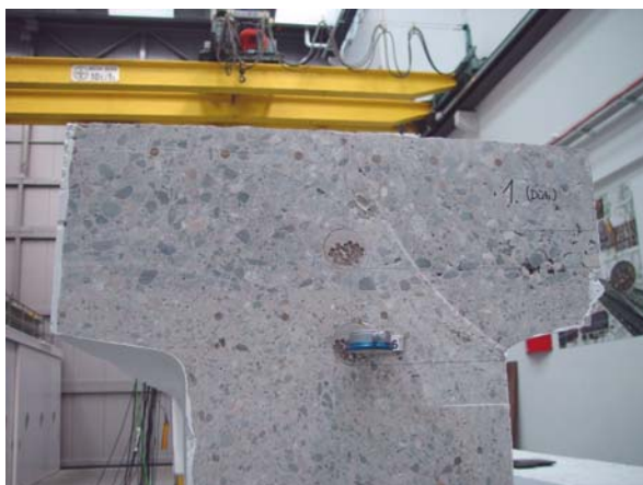
Abbildung 13: Trägerende des Trägers 1 mit den beiden Spannmitgliedern
