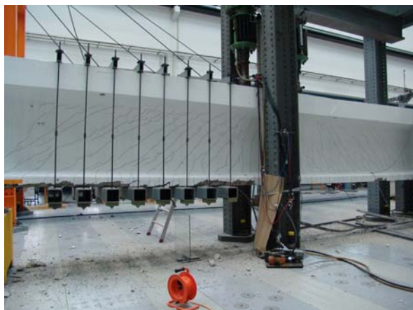
Abbildung 105: Träger 2 kurz nach Bruch, herumliegende Bruchstücke
