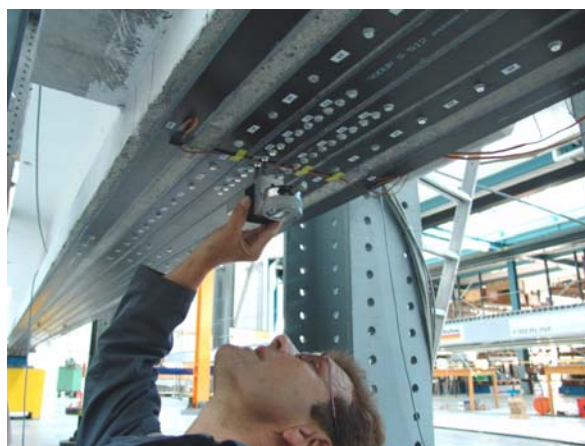
Abbildung 112: Deformetermessung in Trägermitte mit Deformeterlänge 25 mm
