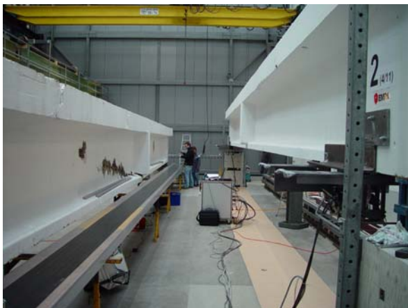
Abbildung 79: Träger 2, Vorbereitungen zum Kleben der vorgespannten CFK-Lamellen
