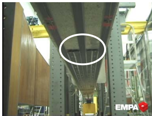
Abbildung 122: Fortgeschrittene Ablösung der kurzen Lamellen
