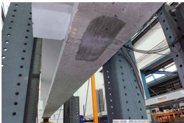
Abbildung 87: Untersicht des Trägers 5, Betonöffnung wieder geschlossen
