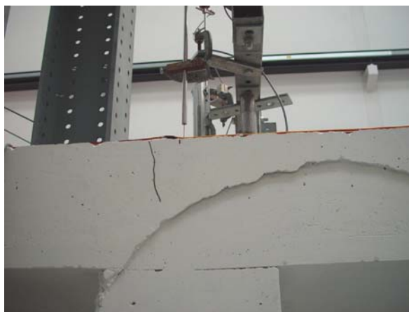
Abbildung 10: Riss in Trägermitte an Oberseite vor der statischen Belastung beim Träger 4
