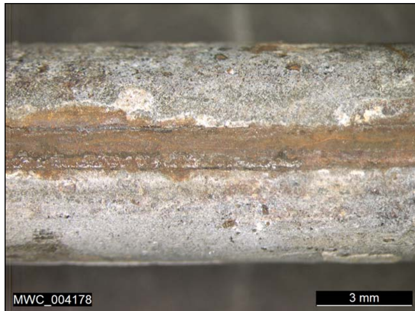
Abbildung 16: Detailansicht eines Drahtes mit 2 mm Rostkrustenspur
