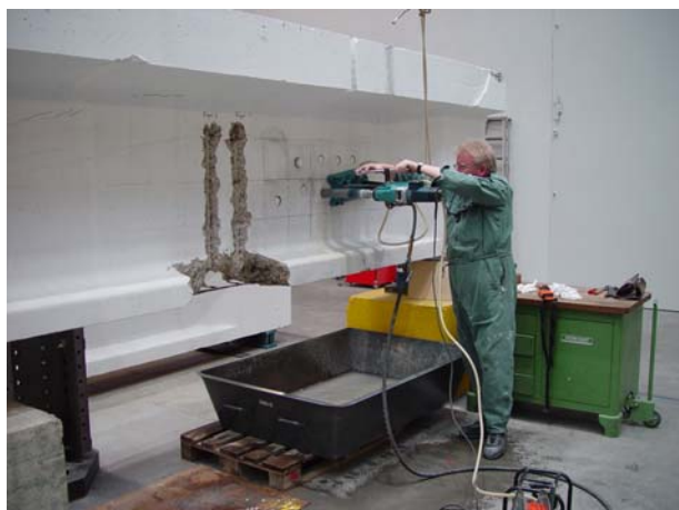
Abbildung 24: Bohrkerntnahme im Steg
