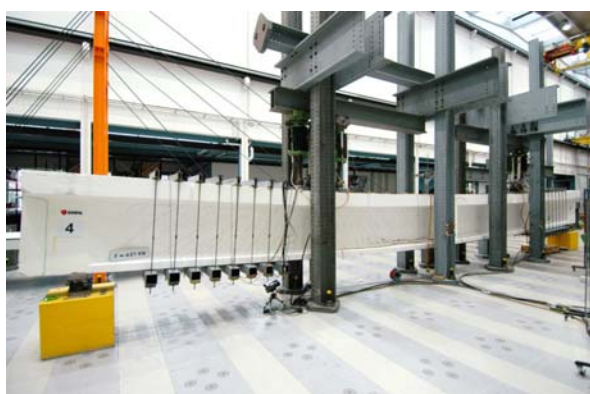
Abbildung 94: Träger 4, stark verformt unter Last, kurz vor Bruch
