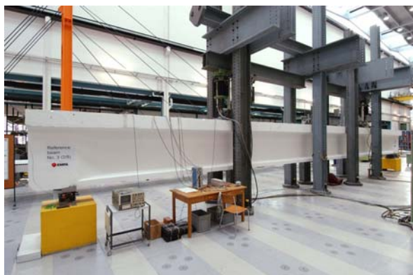
Abbildung 77: unverstärkter Referenzträger 3, Längsansicht in Empa Prüfhalle vor Belastung
