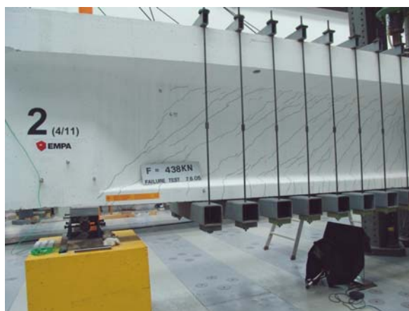
Abbildung 102: Träger 2, Verankerungszone vor Bruch
