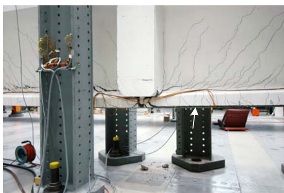
Abbildung 93: Träger 4, fortgeschrittene aber immer noch stabile Delamination
