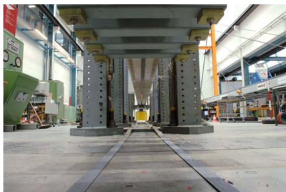
Abbildung 126: Delaminierte lange CFK-Lamellen nach dem Bruch schön hingelegt
