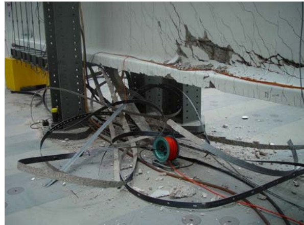
Abbildung 96: Träger 4 nach Bruch, abgelöste CFK-Lamellen
