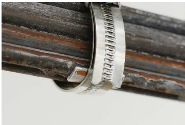
Abbildung 34: Fixierung der Drähte mit einer Bride während dem Durchtrennen
