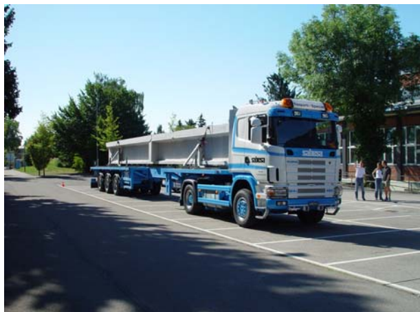
Abbildung 7: Lastwagentransport eines Trägers
