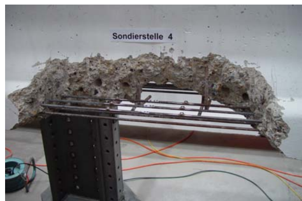
Abbildung 38: Übersicht der Sondierstellen 1 bis 5 für die Spannungsmessungen beim Träger 1 (4/8)
