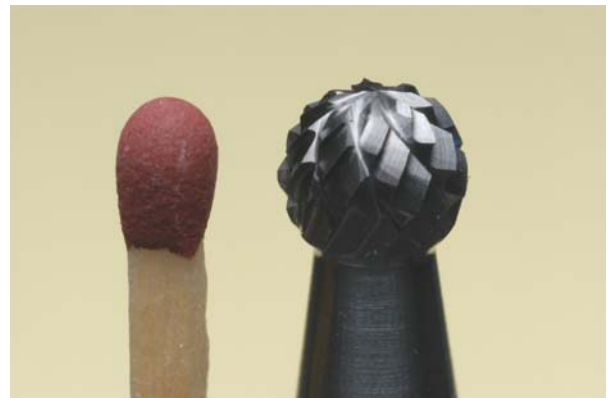
Abbildung 37: Größenvergleich des Kugelhartmetallfrässtifts
