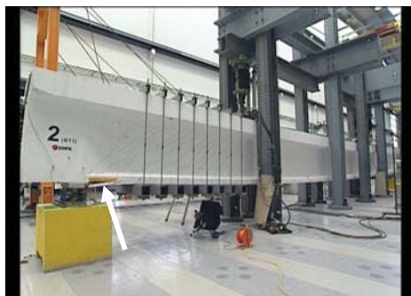
Abbildung 103: Träger 2 während ablösen des Endes der Lamellen
