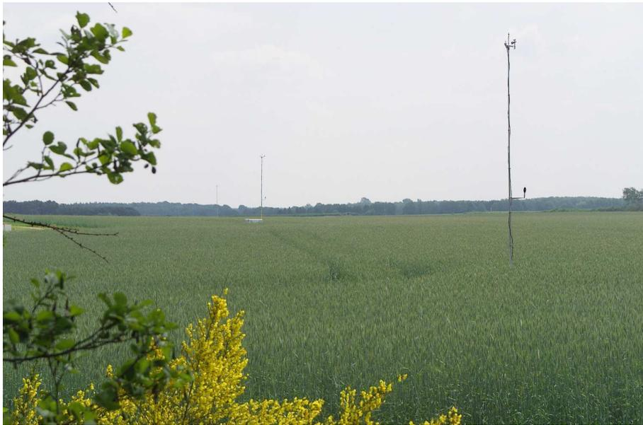
Abbildung 6.29: Die Messpunkte 150 m (rechts im Bild), 300 und 600 m von der Quelle entfernt. Mikrofon und Meteostation sind jeweils am selben Mast befestigt.
