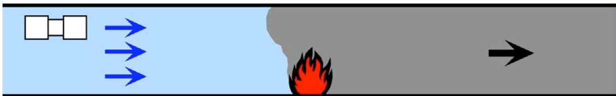
Bild A1-6d Störung der Rauchgasschichtung durch die Belüftung
