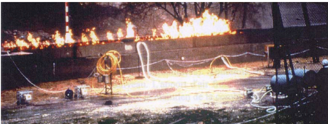
Bild A4-2 Brand in einer Schlitzrinne aus [17]
