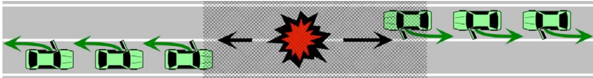
Bild 4 Phase Selbstrettung in einröhrigem Tunnel mit Gegenverkehr
