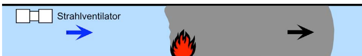
Bild A1-8b Längsströmung beim Betrieb der Tunnellüftung
