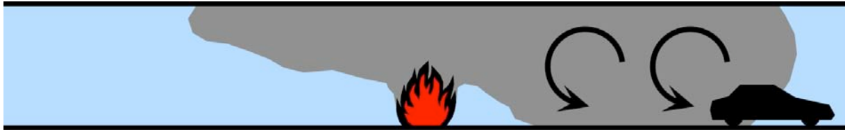
Bild A1-6c Störung der Rauchgasschichtung durch den Verkehr
