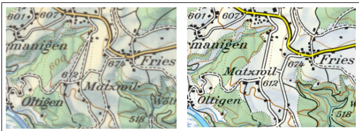
Abbildung 37: Rückbau von Verkehrswegen und der Einfluss auf die Zerschneidungsgeometrie: Eine Strasse, die 1980 (links) noch bestand, ist im Jahr 2002 (rechts) aufgehoben. Dies führt zu einem höheren Wert der effektiven Maschenweite (Beispiel aus dem Berner Seeland/Mittelland bei Detligen mit einem Rückbau einer 3-Kl.-Strasse zwischen 1980 und 2000, (reproduziert mit Bewilligung von swisstopo (BA071415)).
