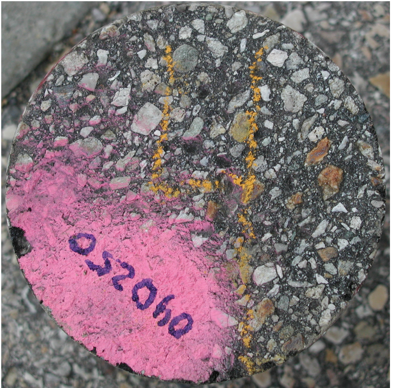
Fig. 11.9: carotte prélevée dans le revêtement de type AB 10 ou AB 16 de la route du col du Simplon à la hauteur du "Gunzigrabenbrücke dans la voie montante. L'âge du revêtement se situe entre 20 et 25 ans. Les dégradations du mastic apparaissent peu prononcées en regard de l'âge du revêtement. Certaines zones présentent par contre des fissurations importantes (fig. 11.10).
