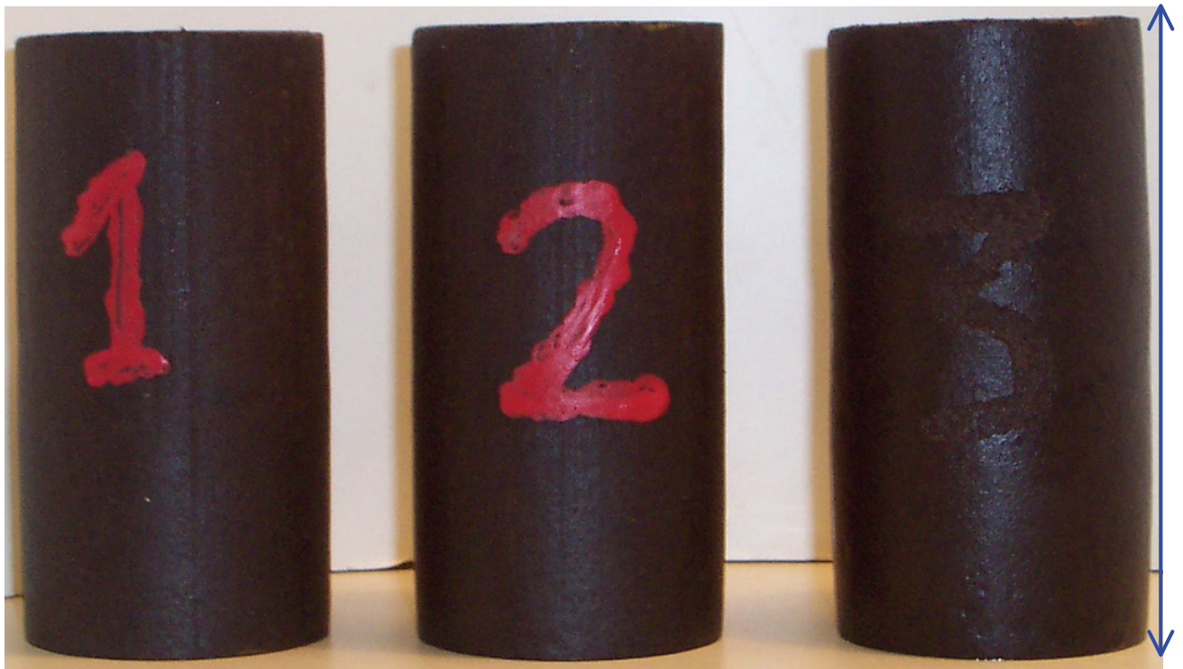
Fig. 10.5: éprouvettes de filler de quartz-bitume après immersion dans l'eau à 40°C (2 ème phase de l'essai). Outre la forte augmentation de volume, ces éprouvettes ont perdu quasiment toute leur consistance. Après immersion dans l'eau à 40°C, ces éprouvettes se sont déformées et tordues sous leur propre poids (exemple marqué par une flèche bleue). Avant l'essai, les éprouvettes ont une hauteur de 100 mm et un diamètre de 55 mm.
