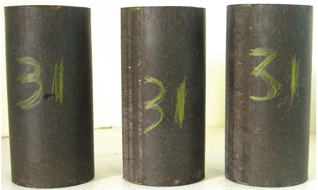
Fig. 10.10: éprouvettes après immersion dans l'eau à 40 °C. Les éprouvettes ne se sont pas ramollies lors de l'immersion dans l'eau et restent dures au toucher. Elles ont seulement blanchi par l'ajout de chaux.
