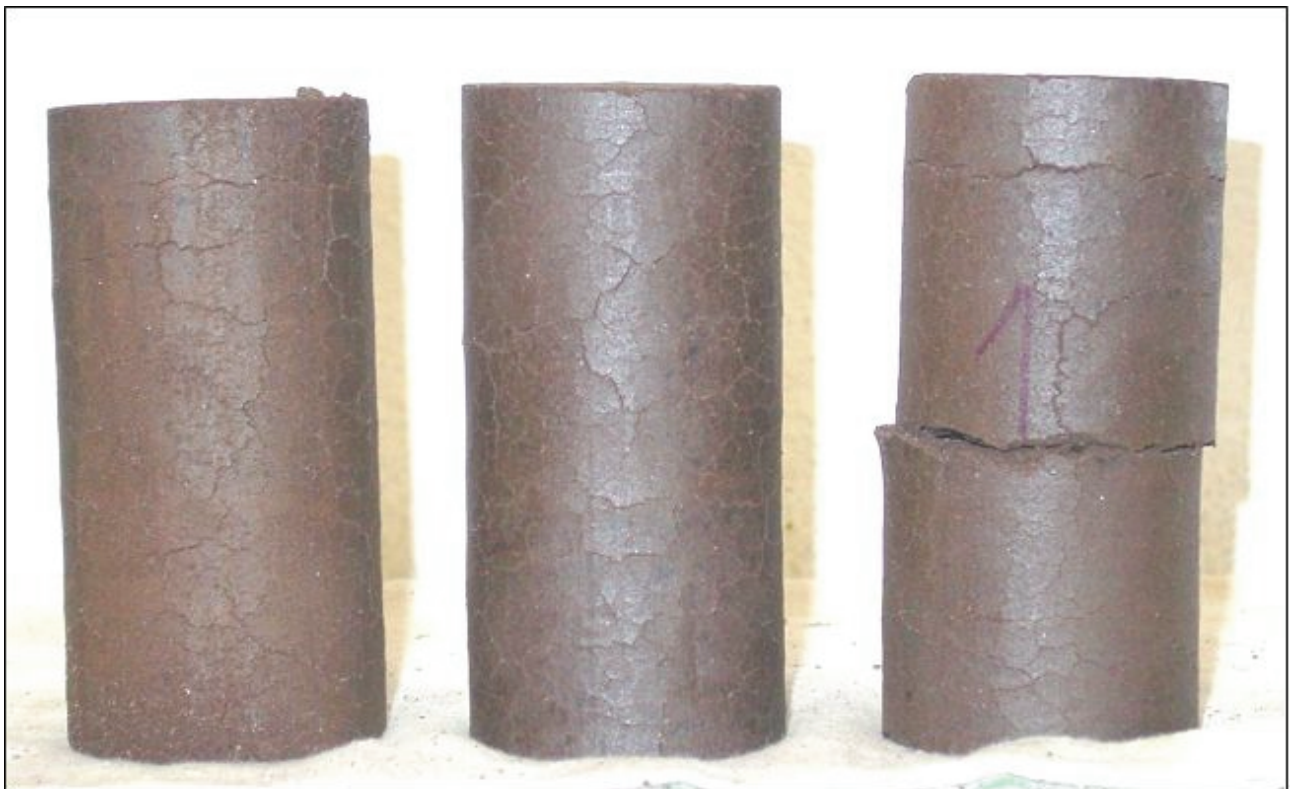
Fig. 10.8: éprouvettes après immersion dans l'eau glacée sous une pression de 25 mbar. Les éprouvettes sont complètement fissurées, voire fragmentées après la 1 ère phase de l'essai déjà. Il n'a pas été possible de procéder à la 2 ème phase de l'essai qui consiste à plonger les éprouvettes dans de l'eau chauffée à 40 °C et de déterminer les modifications du volume. Avant l'essai, les éprouvettes ont une hauteur de 100 mm et un diamètre de 55 mm.
