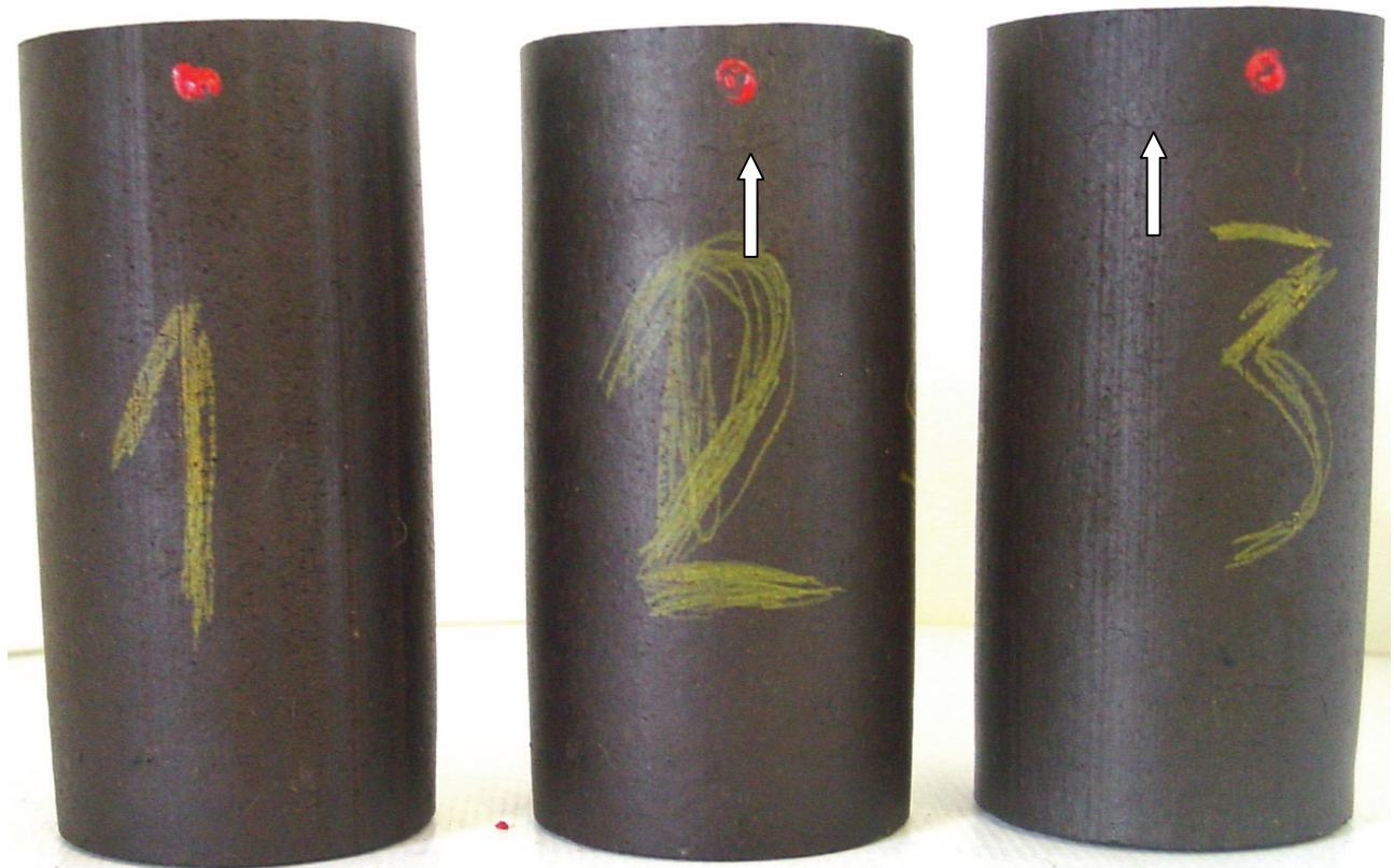
Fig. 10.12 : Les carottes filler-bitume ont augmenté de volume de manière significative après immersion dans l'eau à 40°C pendant 24 heures et une à deux fissures (exemples marqués par des flèches) sont apparues à la surface de chaque carotte. Les éprouvettes sont restées rectilignes. Avant l'essai, les éprouvettes ont une hauteur de 100 mm et un diamètre de 55 mm.
