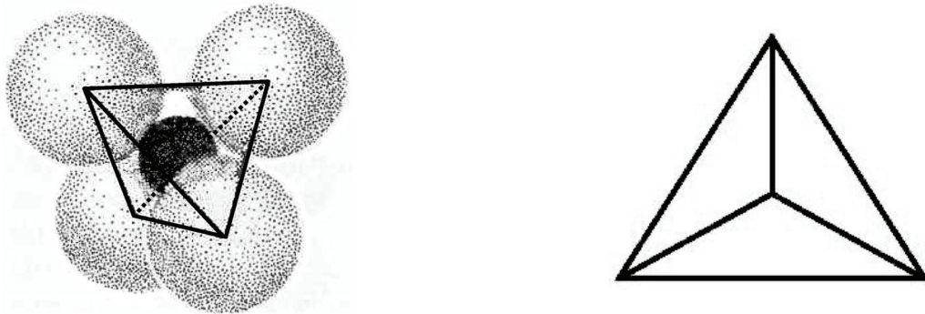
Fig. 2.2: Le groupe anionique [\text{SiO}_4]^{4-} est constitué d'un cation de silicium [\text{Si}^{4+}] entouré de quatre anions d'oxygène [\text{O}]^{2-} qui occupent les sommets d'un tétraèdre imaginaire représenté dans la figure de droite.
