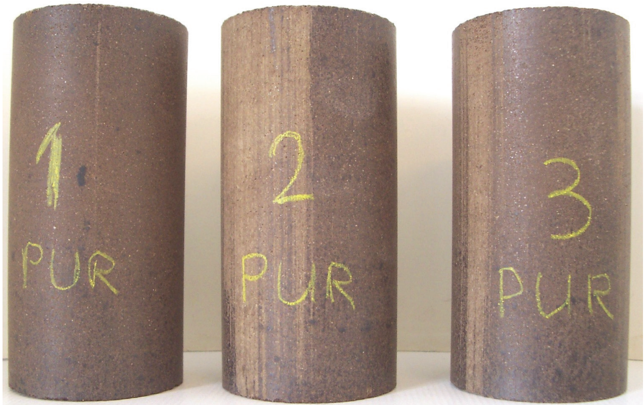
Fig. 10.4: éprouvettes de filler de référence après immersion dans l'eau à 40°C. L'augmentation de volume est très faible et aucune modification macroscopique des éprouvettes n'a été détectée. Le filler de référence apparaît quasiment insensible à l'eau. Hauteur = 100 mm, diamètre = 55 mm.
