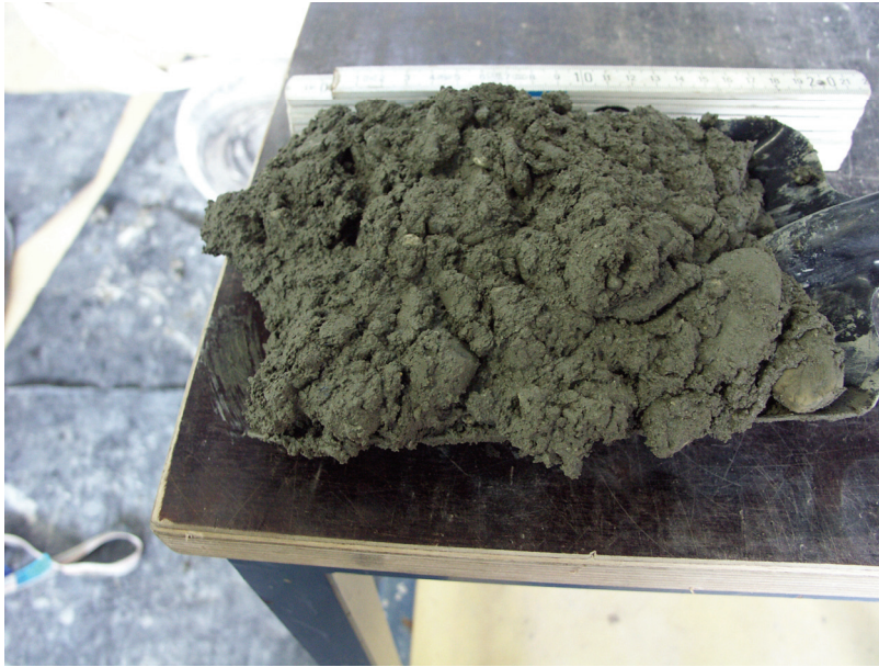
Fig. 12.1: photographies de la gâchée de béton frais avec ajout de 7.5 % de filler de bentonite.
