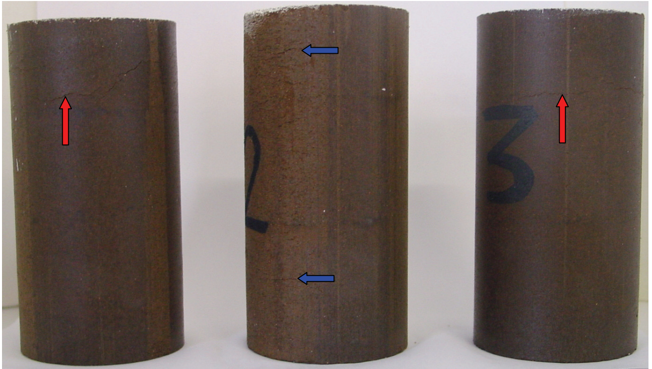
Fig. 10.6: éprouvettes de filler de référence dopé avec 10 % de kaolinite. De nombreuses fissures se sont développées lors de la phase d'immersion dans l'eau à 40°C. Deux types de fissures sont visibles, d'une part de longues fissures pénétrant les éprouvettes profondément (exemples marqués par des flèches rouges) et d'autre part une série de très nombreuses petites fissures ouvertes situées plus ou moins perpendiculairement à l'axe du cylindre (exemples indiqués par des flèches bleues), ou respectivement parallèlement aux bases circulaires de l'éprouvette cylindrique. Avant l'essai, les éprouvettes ont une hauteur de 100 mm et un diamètre de 55 mm.
