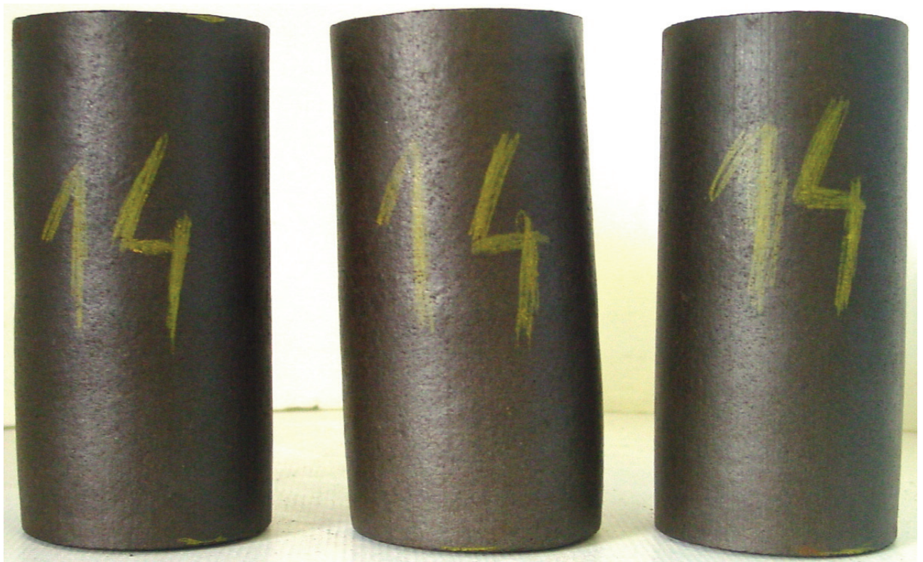
Fig. 10.9: éprouvettes après immersion dans l'eau à 40 °C. Les éprouvettes ont fortement augmenté de volume (> 20 %). Les éprouvettes se sont en outre déformées en forme de tonneau sous leur propre poids. Elles ont perdu pratiquement toute consistance et sont devenues molles au toucher après immersion dans l'eau à 40 °C.
