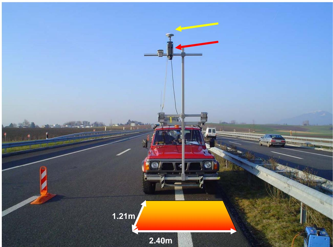
Figure 3: Installation de thermographie mobile de l'Empa et surface enregistrée par image, flèche rouge = caméra infrarouge, flèche jaune = antenne GPS
