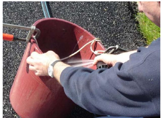
Figure 14: Mesure du débit sortant et entrant.
