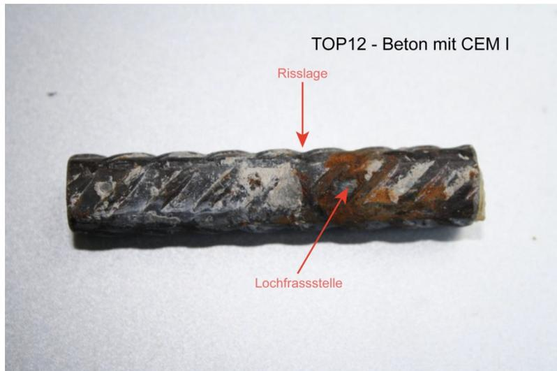
Abb. 4.8 Ausgebauter Top12-Stab nach dem Durchflussversuch
