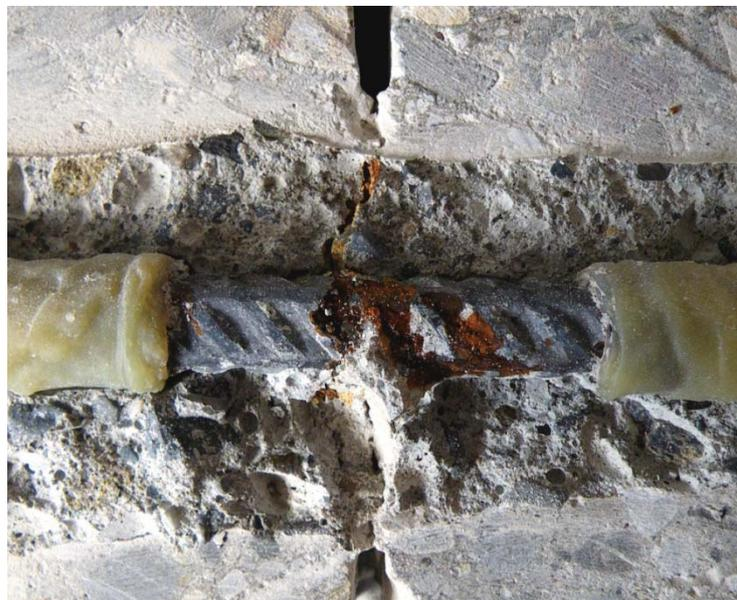
Abb. 4.9 Seitlich ausgedehnter Korrosionsangriff am normalen Betonstahl im Rissbereich, ergänzende Versuche mit Rissbildung an der HSR
