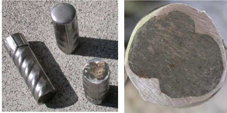
Abb. 2.2 Ansichten und Querschnitte von mit nichtrostendem Stahl ummanteltem Betonstahl (Nuovinox, #5,  $\varnothing$  15.9 mm). Fotos: F. Hunkeler
