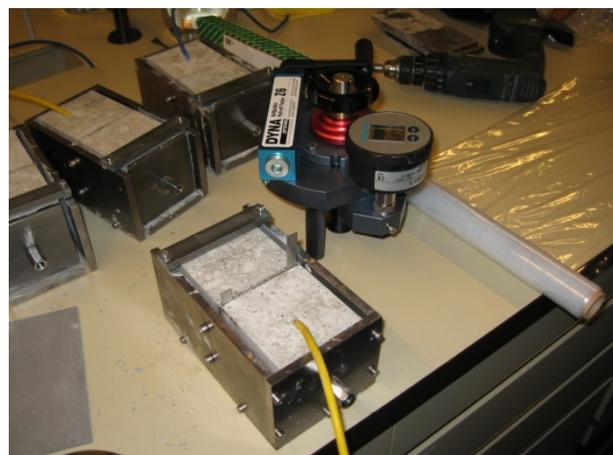
Abb. 3.9 (rechts) Offenhalten des Risses mittels 0.5 mm dicken Stahlplättchen
